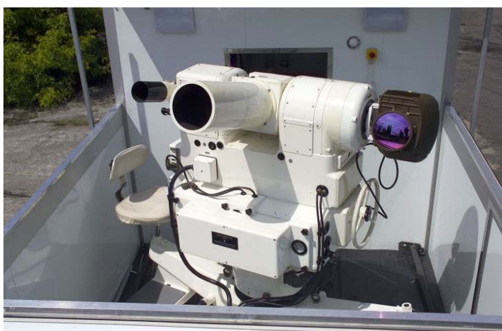
Rys. 3. Stacja śledząca (kinofototeodolit EOTS-F) z kamerą podczerwieni firmy SAGEM typu IRIS
