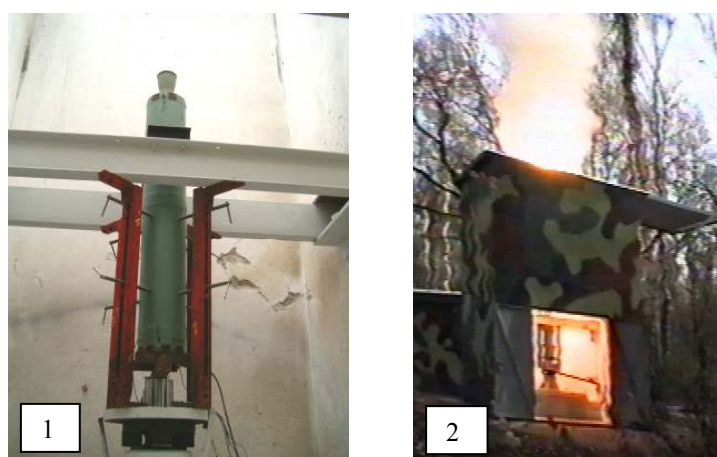
Zespół napędowy rakiety OSA na hamowni pionowej: 1-przed odpaleniem. 2-podczas pracy zespołu.
