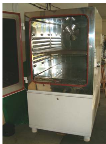
Komora klimatyczna do badań zespołów raket w warunkach intensywnego oddziaływania czynników klimatycznych.
