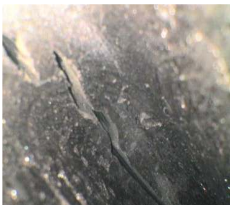
Pęknięcia paliwa raketowego wykryte za pomocą endoskopu
