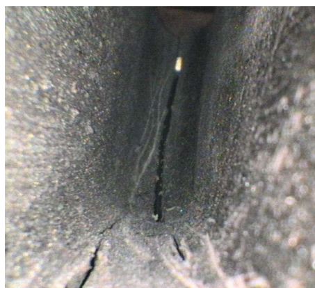
Pęknięcia paliwa raketowego wykryte za pomocą endoskopu
