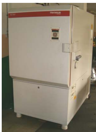
Komora klimatyczna do badań zespołów raket w warunkach intensywnego oddziaływania czynników klimatycznych.
