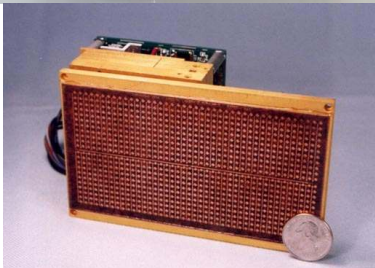
Rys. 6. Radar CW/FM 76.5GHz z płaską dwuwiazkową anteną amerykańskiej firmy Epsilon-Lambda.
