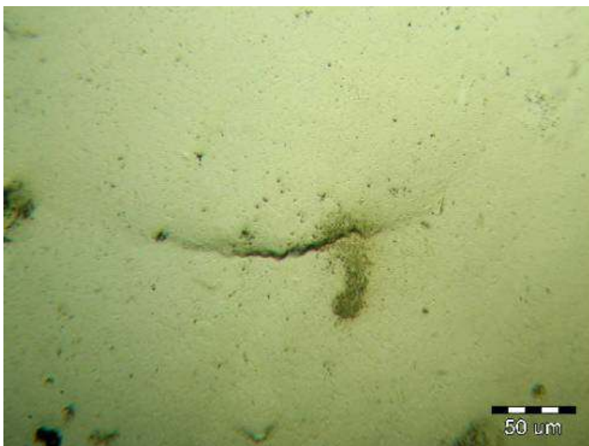
Rys.14. Jak na Rys.12 – większe powiększenie. Widoczne pojedyncze mikropęknięcia na brzegu pęcherza wodorowego. Pow. 365x
