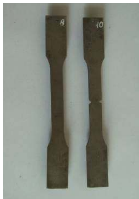
Rys.2. Widok próbki bez karbu (po lewej stronie) i z karbem (po prawej stronie)
