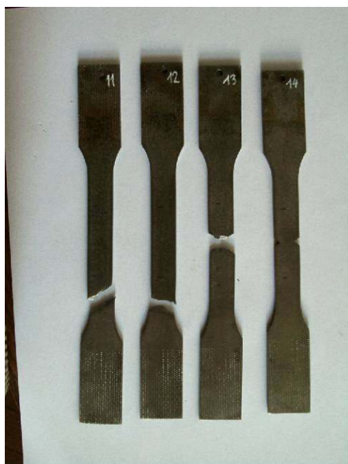
Rys.22. Wygląd próbek wodorowanych po próbach rozciągania.
