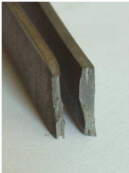
Rys.25. Porównanie wyglądu przełomu próbki nie wodorowanej (po lewej stronie) i wodorowanej (po prawej stronie). W próbce wodorowanej na przełomie widoczne są szczeliny i pęknięcia spowodowane nawodorowaniem. Próbka wodorowana wykazuje znacznie mniejsze przewężenie niż próbka nie wodorowana. Pow.4,0x
