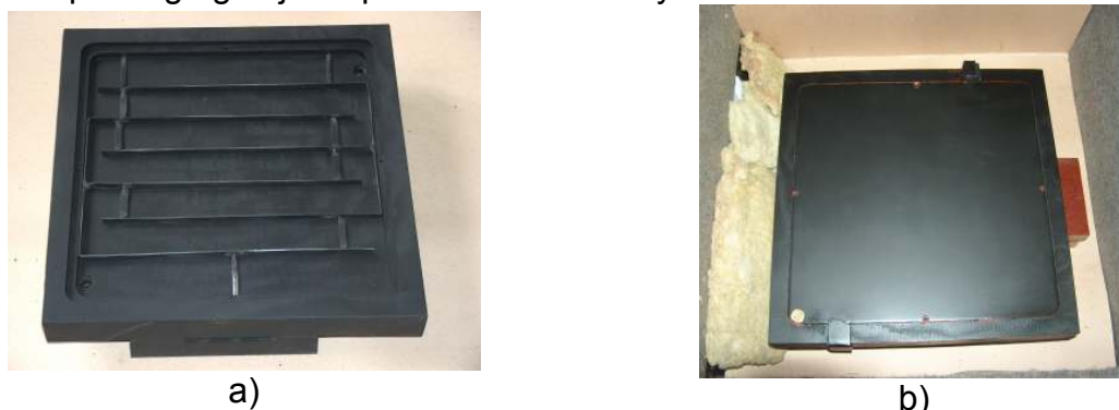
Rys. 3. Grzejnik przystosowany do grzania olejowego – a) labiryntowy układ obiegu oleju, b) kompletny grzejnik
