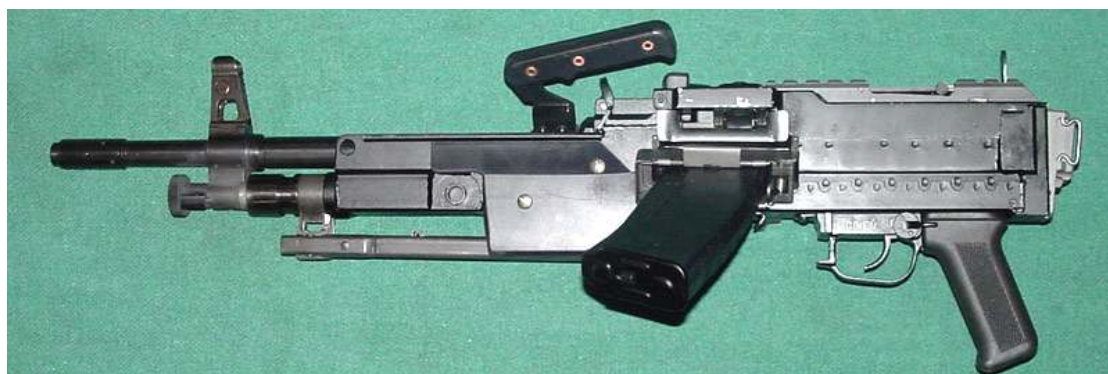
Rys. 9. 5,56x45mm krajowy LKM wz.2003 z magazynkiem, kolba złożona -prototyp
