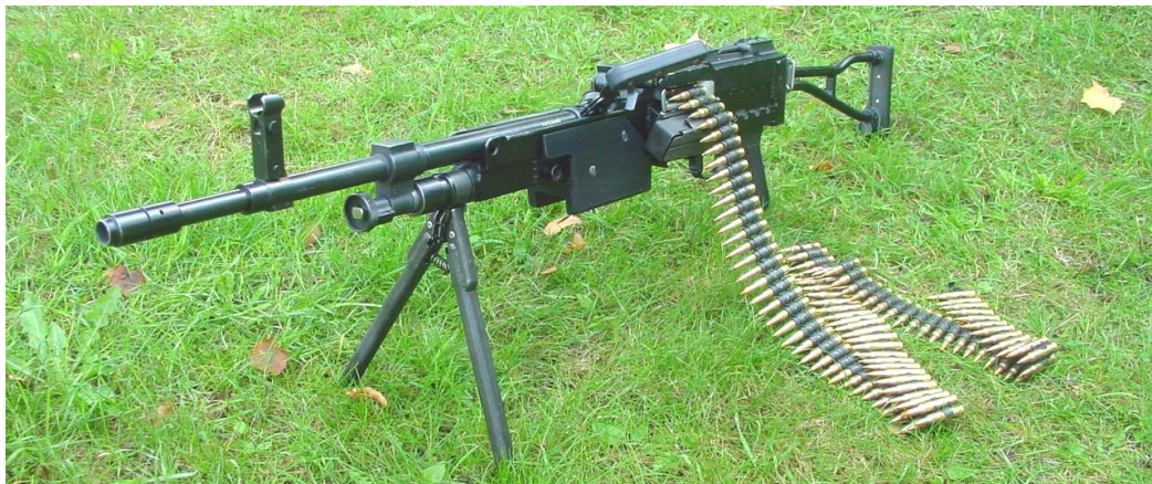
Rys. 8. 5,56x45mm krajowy LKM wz.2003 z zasilaniem taśmowym -prototyp
