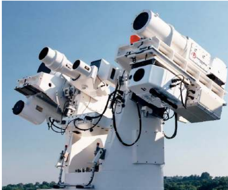
Rys. 5. Stacja śledząca optoelektroniczna wielosensorowa z automatycznym śledzeniem z wykorzystaniem wideotrakera IR i TV z kamerami filmowymi oraz z kamerą wideo zdjęć szybkich, produkcji firmy L-3 BRASHEAR - USA
