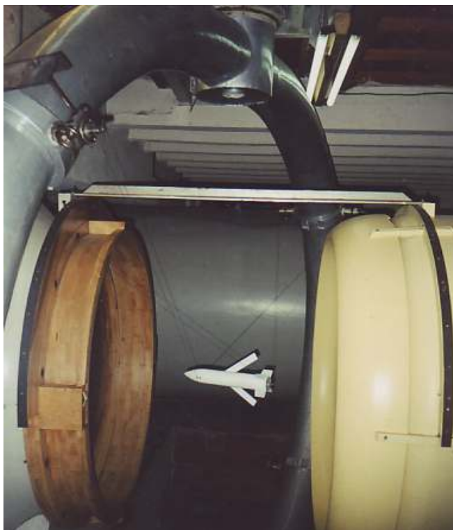
Rys. 10. Model bomby z widocznym adapterem o rozwarciu skrzydeł 60deg zawieszony na wadze w tunelu aerodynamicznym Zakładu Aerodynamiki, ITLiMS Politechnika Warszawska
