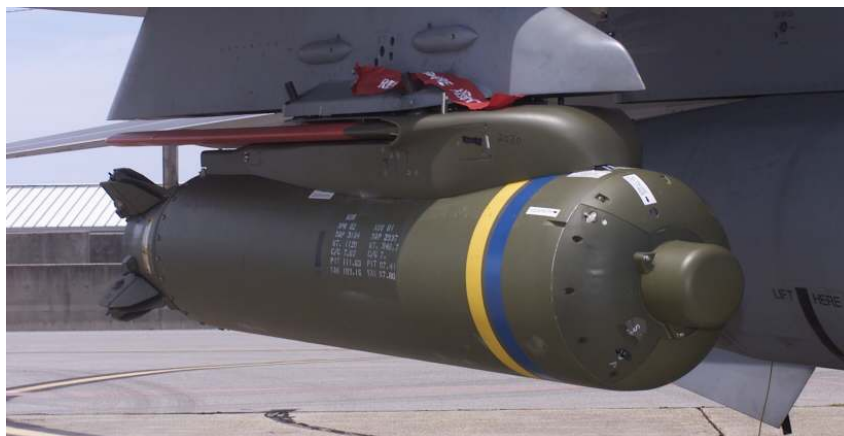
Rys. 2. Bomba kasetowa Rockeye z adapterem LongShot [3,21] podwieszona pod skrzydłem samolotu
