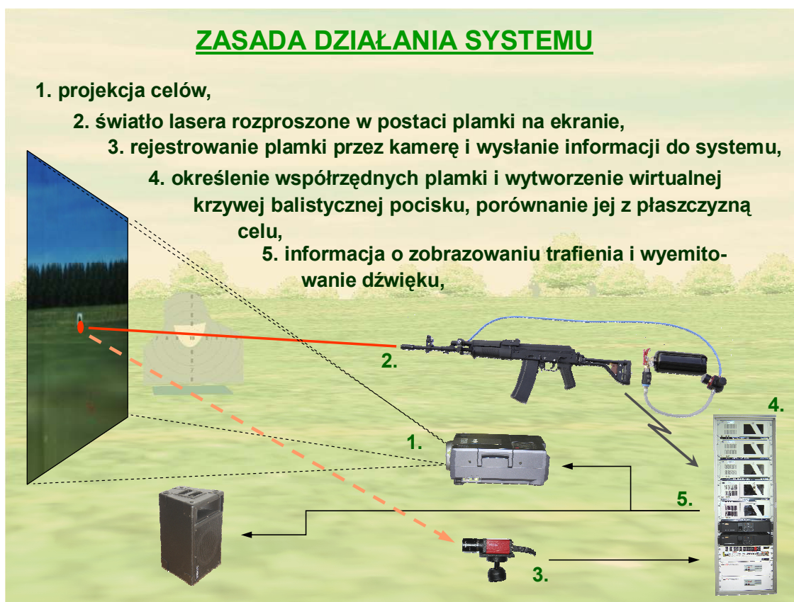
Rys. 1. Zasada działania systemu do symulowanych strzelań z broni strzeleckiej.
