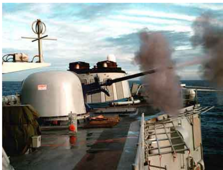
Rys. 2. 76 mm armata okrętowa Mk 75 na pokładzie fregaty raketowej typu Oliver Hazard Perry w czasie wykonywania zadań ogniowych.
