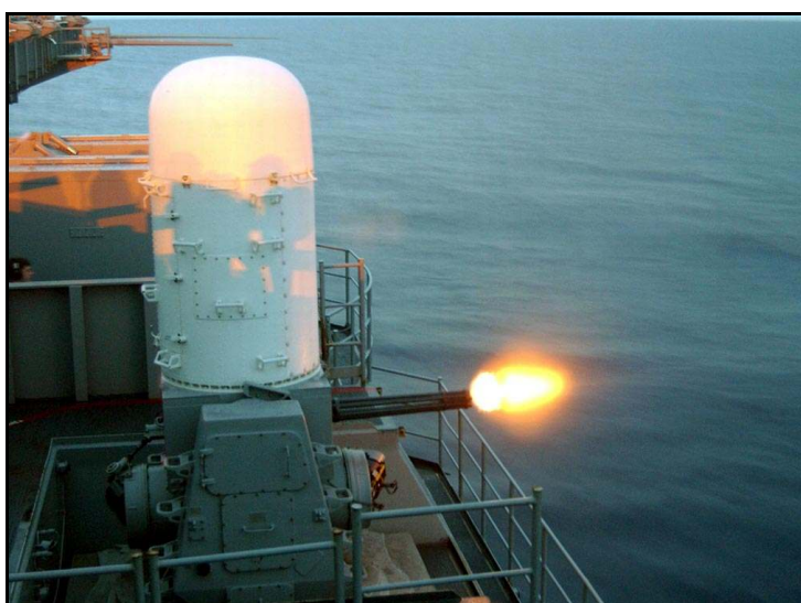
Rys. 3. 20mm zestaw CIWS Mk 15 w czasie wykonywania zadań ogniowych.
