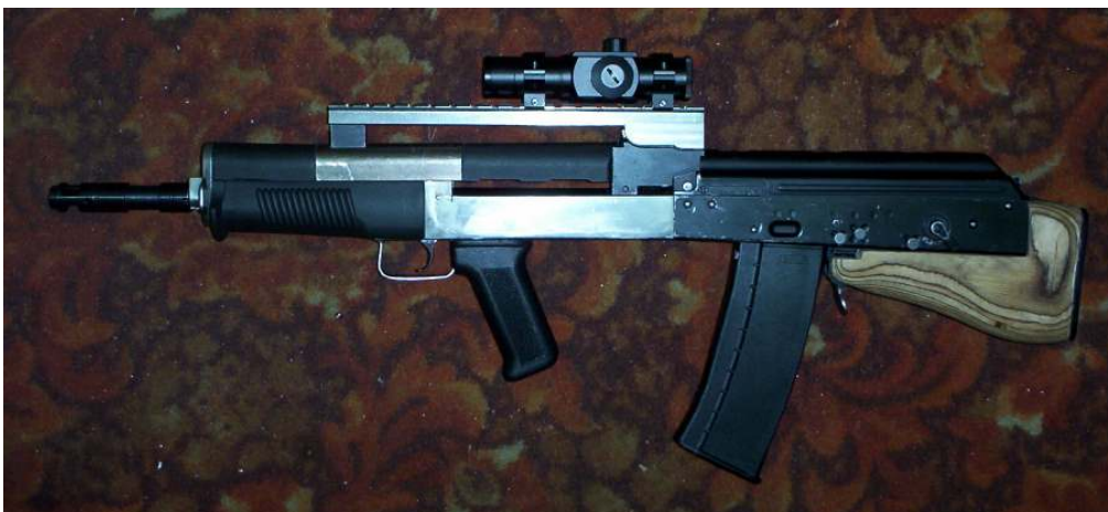
Fot.2. Model badawczy 5,56 mm karabinka bezkolbowego wz.2005 JANTAR (widok z lewej strony) (M. Binek)
