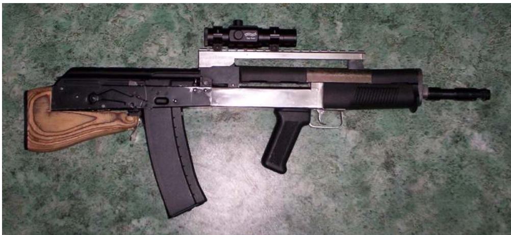
Fot.1. Model badawczy 5,56 mm karabinka bezkolbowego wz.2005 JANTAR (widok z prawej strony) (M. Binek)
