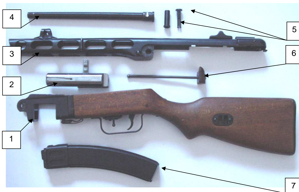
Rys. 6. Widok istotnych części broni 7,62 mm PPSz wz.41: 1 –dolny zsp. komory zamkowej; 2 – zamek; 3 -górny zsp. komory zamkowej; 4 –lufa oraz widok pozostałych części broni częściowo rozłożonej, z odłączoną lufą; 5 –kołek rozprężny i oś główna; 6 –zsp. sprężyny powrotnej; 7 -magazynek
