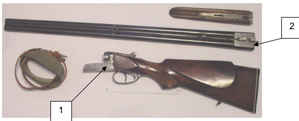
Rys. 5. Widok istotnych części broni myśliwskiej śrutowej: 1 -baskila; 2 -lufy
