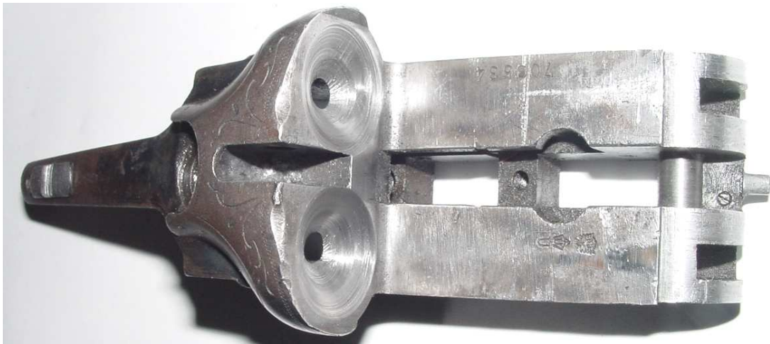
Rys. 10. Widok baskili po rozwierceniu otworów iglic na płaszczyźnie czołowej i napawaniu gniazda współpracującego z występem w tylnej części luf.
