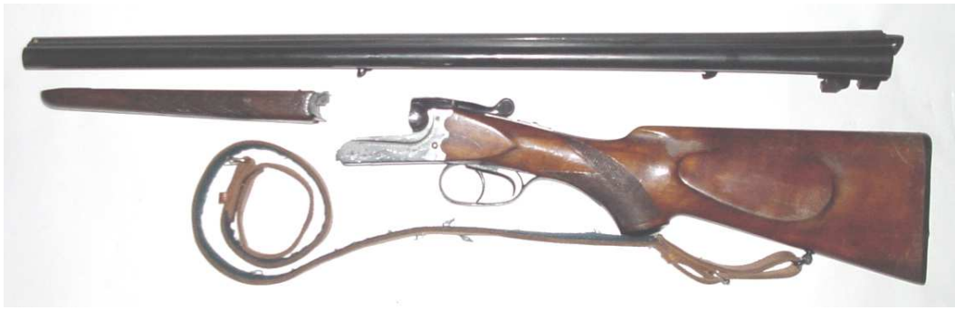
Rys. 9. Widok dubeltówki Merkel kal. 16/70 pozbawionej cech użytkowych w stanie rozłożonym.
