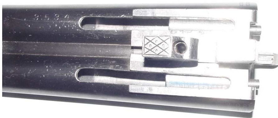
Rys. 11. Widok otworów wykonanych w tylnej części luf oraz umiejscowionych w komorach naboju wkładek zaślepiających.
