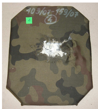
Rys. 2. Wkład balistyczny dodatkowy po badaniach balistycznych w temperaturze +50 °C
