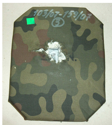
Rys. 1. Wkład balistyczny dodatkowy po badaniach balistycznych w temperaturze -40 °C
