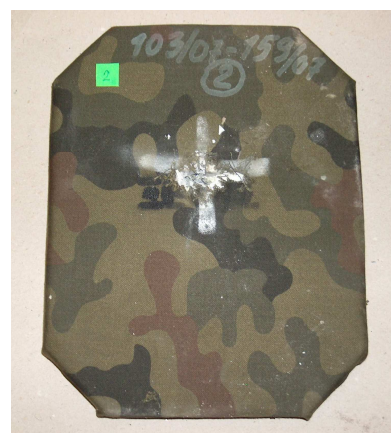
Rys. 3. Wkład balistyczny dodatkowy po badaniach balistycznych w stanie po deszczowaniu
