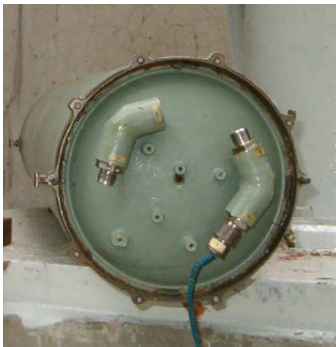
Fot. 5. Sposób podłączenia linii odpalania do złącza elektrycznego pironaboju.
