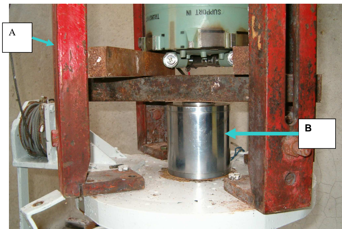
Fot. 6. Sposób umieszczenia czujnika siły ciągu. A - uchwyty do mocowania zespołu napędowego na stanowisku pomiarowym, B - czujnik siły ciągu.
