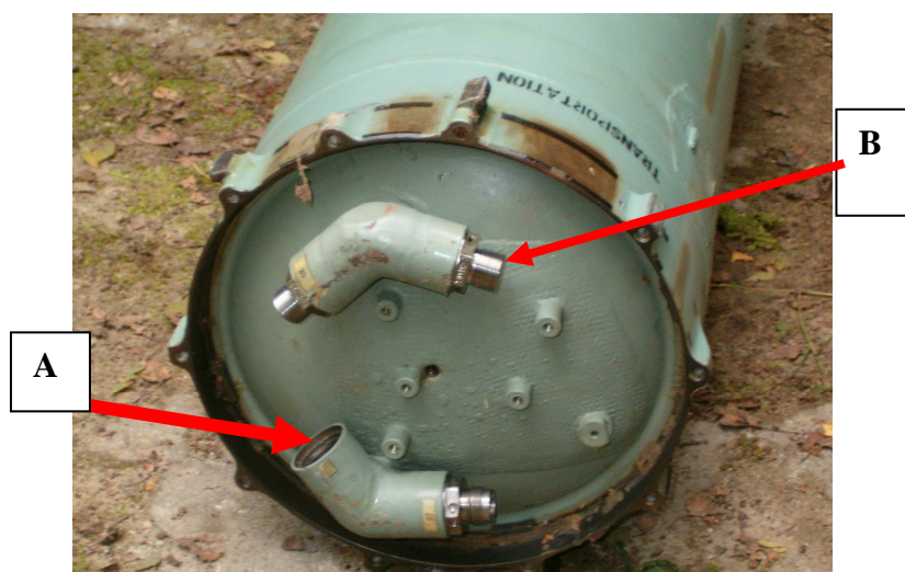
Fot. 3. Dno komory spalania zespołu napędowego: A – miejsce wkręcenia czujnika pomiarowego ciśnienia z reduktorem, B- złącze elektryczne pironaboju.
