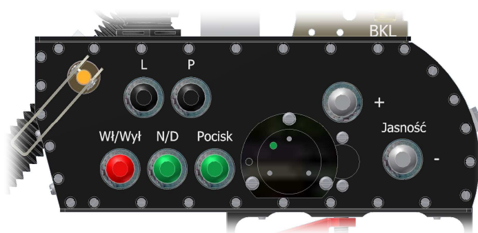
Rys. 5 Panel boczny celownika z przyciskami sterującymi pracą celownika
