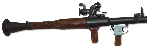
Rys. 1 Granatnik RPG-7 produkcji rosyjskiej z celownikiem optyczno-mechanicznym PGO-7 produkcji rosyjskiej. [zdjęcie WITU]
