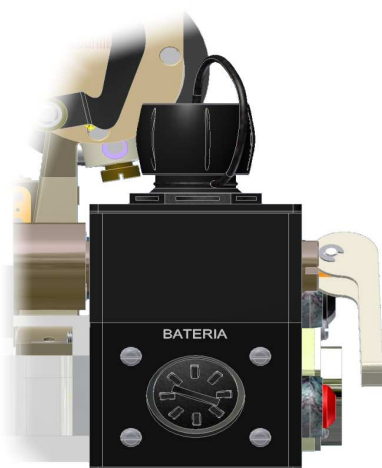
Rys. 9 Widok tylnej ścianki celownika. Widoczne zamknięcie komory na baterie.
