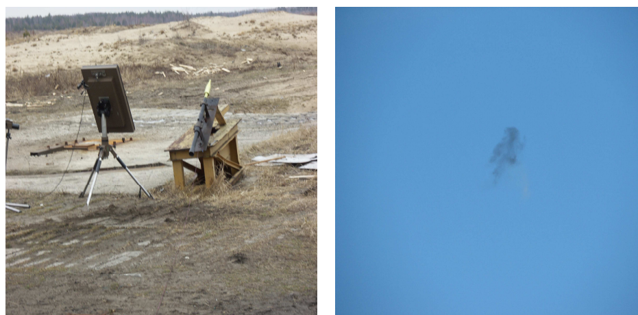
Rys. 17 Załadowany nabój KO-7WM do strzału oraz moment zadziałania samolikwidatora Źródło: opr. wł.
