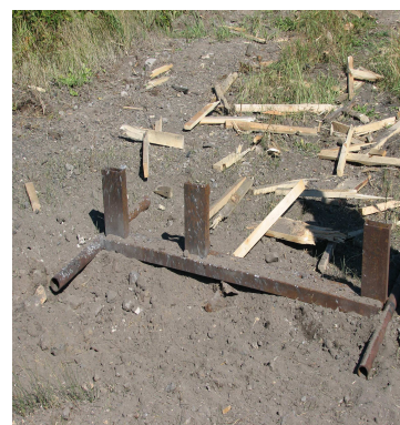
Rys. 12 Tarcze w momencie uderzenia i po strzale dla przykładowych pocisków podczas badania górnej granicy uzbrajania zapalnika – działanie prawidłowe.
