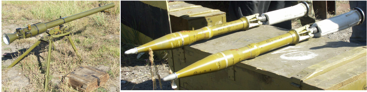
Rys. 6 Stacjonarny granatnik SPG-9M bez celownika i wystrzeliwane z niego naboje PG-9W Źródło: opr. wł.
