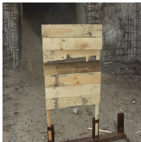
Rys. 11 Tarcze podczas badania dolnej granicy uzbrajania zapalnika: - z lewej strony o wymiarach 0,5x0,5 m ustawiona w odległości 15 m przed próbą, - z prawej strony o wymiarach 1x1 m ustawiona w odległości 10 m po strzale.
