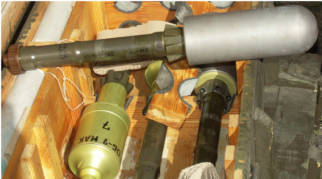
Rys. 9 Nowo opracowywane pociski dymny i kumulacyjno-odłamkowy do granatnika RPG-7 produkcji Zakładów Metalowych „Dezamet” S.A. Źródło: opr. wł.
