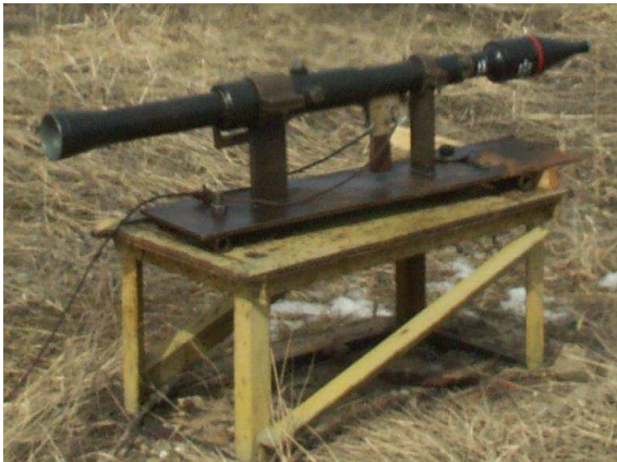
Rys. 10 Zamocowany do stendu granatnik RPG-7 bez celownika optycznego (z lewej strony z nowo opracowanym nabojem KO-7WM) Źródło: opr. wł.
