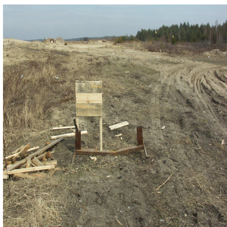
Rys. 11 Tarcze podczas badania dolnej granicy uzbrajania zapalnika: - z lewej strony o wymiarach 0,5x0,5 m ustawiona w odległości 15 m przed próbą, - z prawej strony o wymiarach 1x1 m ustawiona w odległości 10 m po strzale.
