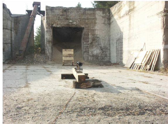
Rys. 10 Zamocowany do stendu granatnik RPG-7 bez celownika optycznego (z lewej strony z nowo opracowanym nabojem KO-7WM) Źródło: opr. wł.
