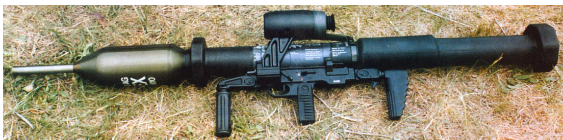
Rys. 4 Ręczny granatnik przeciwpancerny Pancerfaust-3 z nabojem tandemowym
