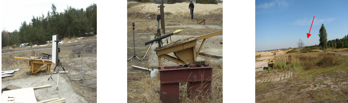
Rys. 16 Stend i zestaw DR-5000, załadowany nabój KO-7WM oraz moment upadku pocisku Źródło: opr. wł.
