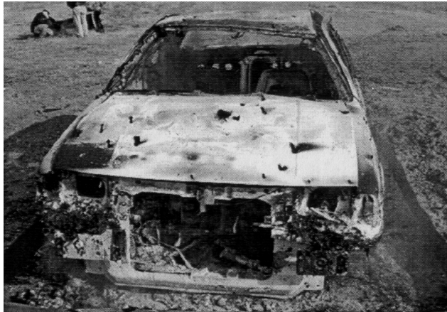
Rys.4a. Samochód po ostrzeleniu pociskiem kartaczowym (widok z przodu).
