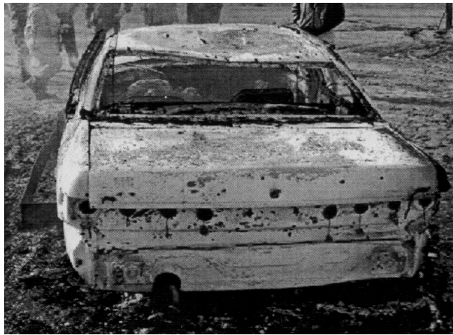
Rys.4b. Samochód po ostrzeleniu pociskiem kartaczowym (widok z tyłu).
