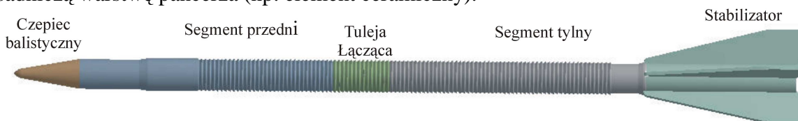
Rys. 6. Model penetratora o konstrukcji segmentowej pocisku podkalibrowego opracowany w Wojskowym Instytucie Technicznym Uzbrojenia
