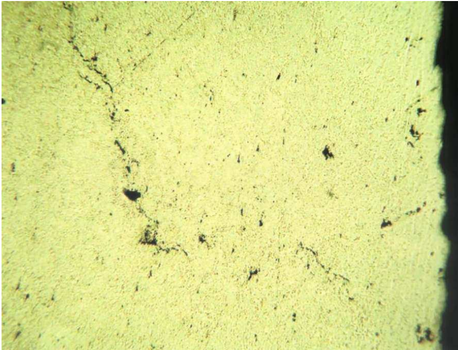
Rys. 4. Przekrój poprzeczny próbki ze stali 30HGSA. Widoczne pęknięcia wywołane wnikaniem wodoru. Przekrój i szlif metalograficzny wykonano po wodorowaniu. Próbka trawiona nitałem. Pow. 170x.
