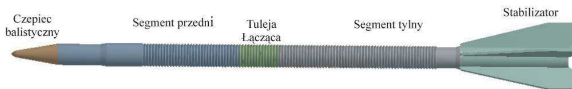
Rys. 4. Model pocisku podkalibrowego APFSDS o konstrukcji segmentowej opracowany w Wojskowym Instytucie Technicznym Uzbrojenia
