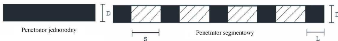
Rys. 3. Schemat konstrukcji penetratora jednorodnego i segmentowego
