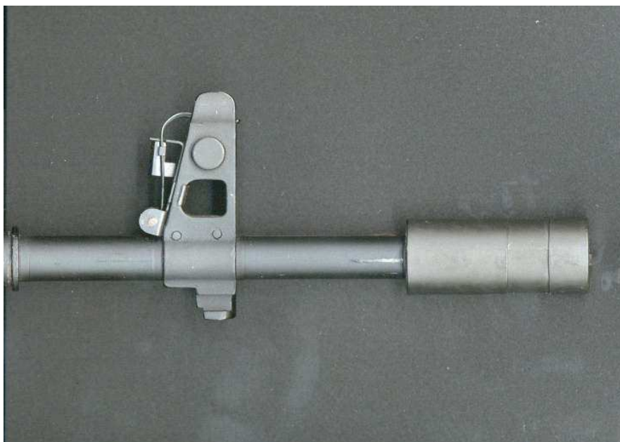
Rys. 11. Model osłony nałożony na urządzenie wylotowe 5.56 mm kbks wz. 1996
