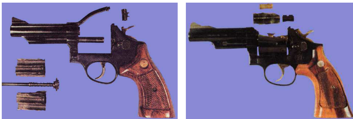
Rys. 2. Widok broni uszkodzonej na wysokości komory nabojeowej i stożka przejściowego (bęben nabojeowej) w wyniku zanieczyszczenia przewodu lufy cząstkami stałymi pochodzącymi z materiałów amunicji
