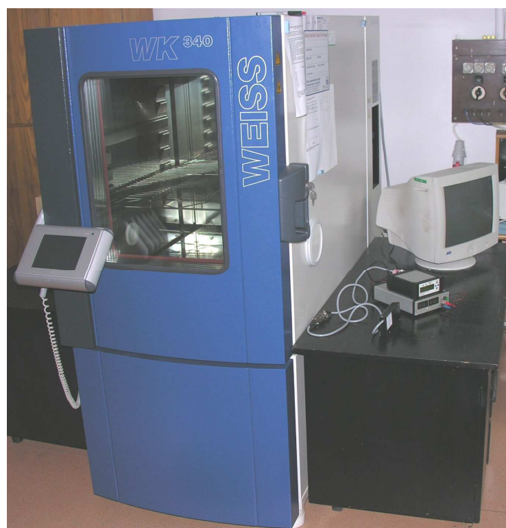
Rys. 3. Widok komory klimatycznej do zadawania żądanych temperatur w celu zbadania wpływu temperatury na parametry techniczne badanych układów zabezpieczeń UZ-K3
