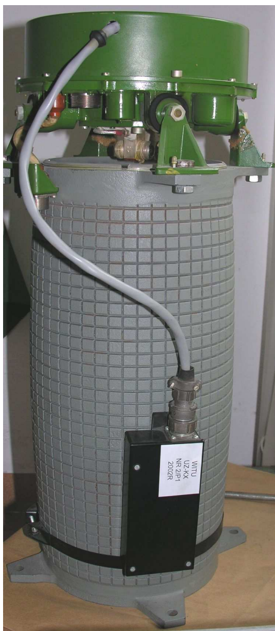
Rys. 2. Widok miejsca montażu układu zabezpieczenia UZ-KX na ładunku rakiety 3M9ME i podłączenia do radiozapalnika.
