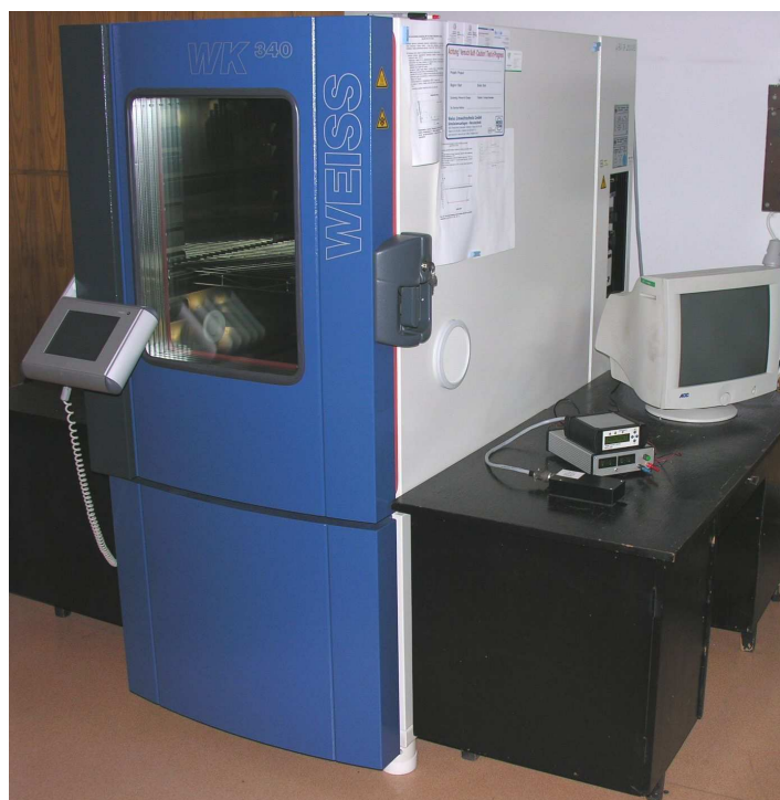
Rys. 3. Widok komory klimatycznej do zadawania żądanych temperatur w celu zbadania wpływu temperatury na parametry techniczne badanych układów zabezpieczeń UZ-KX
