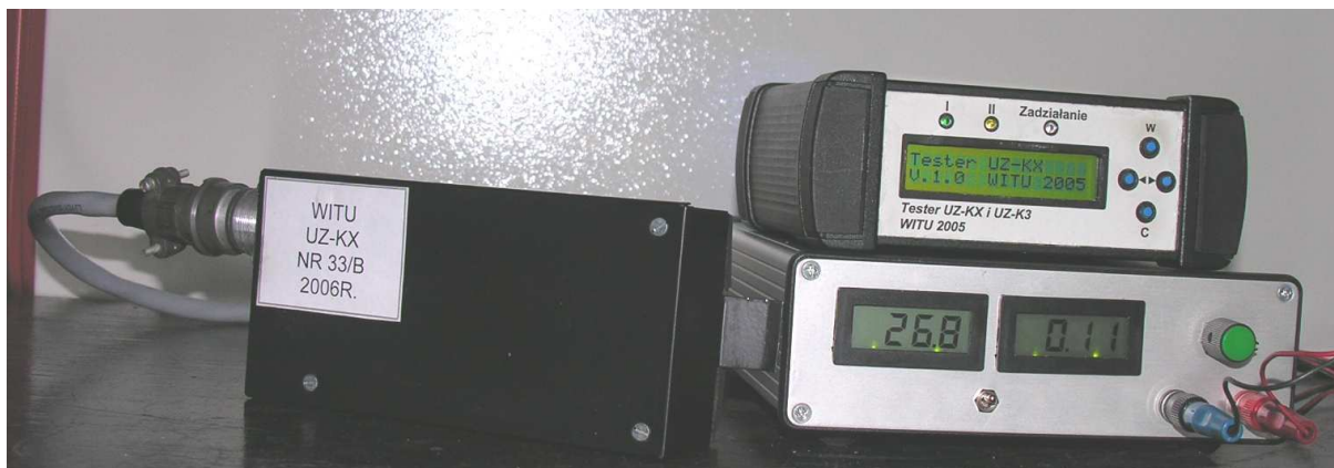
Rys. 1. Widok stanowiska do pomiarów parametrów technicznych układów zabezpieczeń UZ-KX.
