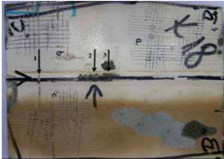
Fot. 1. Powierzchnia zewnętrzna próbki z zaznaczonymi miejscami badania spoiny.
