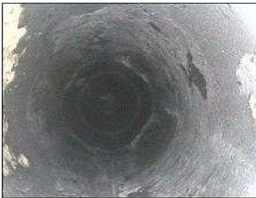
Fot. 6. Rakieta 9M33M2, nr YБ 8173, wewnątrz komory spalania, widoczne obszary zniszczonego pokrycia termicznego, bez uszkodzeń zewnętrznych, widok od strony dyszy.
