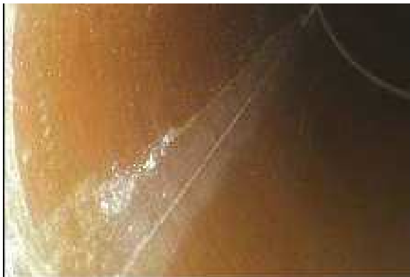
Fot. 3. Rakieta 9M33M3, nr ФП 4418, wewnątrz komory spalania – widoczny szew łączący wykładzinę.
