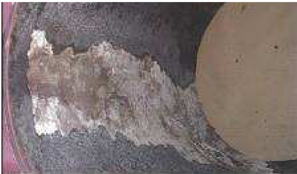
Fot. 4. Rakieta 9M33M2, nr ДЯ 6555, wewnątrz komory spalania, widoczne miejsca przegrzania, wypalania i ubytki pokrycia termicznego – pobrany wycinek O1 do badań materiałowych.
