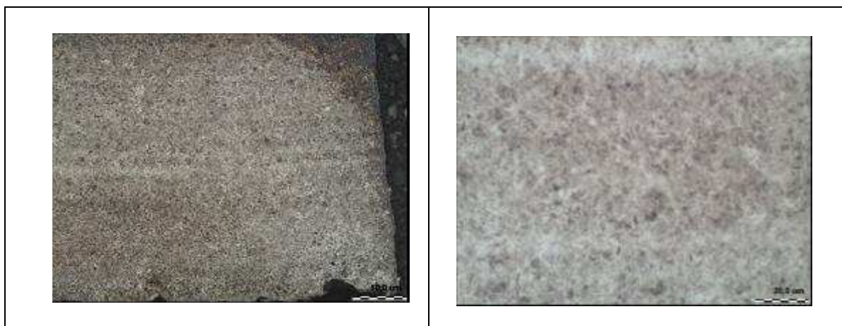
Fot. 10. Obraz struktury materiału przegrzanego z elementu 01
