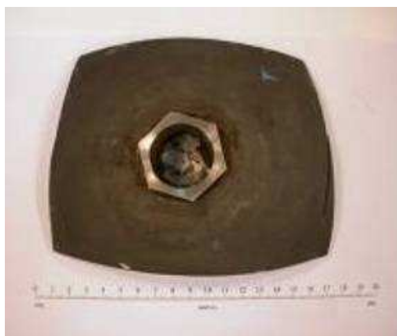
Rys.21. Widok powierzchni zewnętrznej i wewnętrznej wycinka K12, króciec technologiczny.
