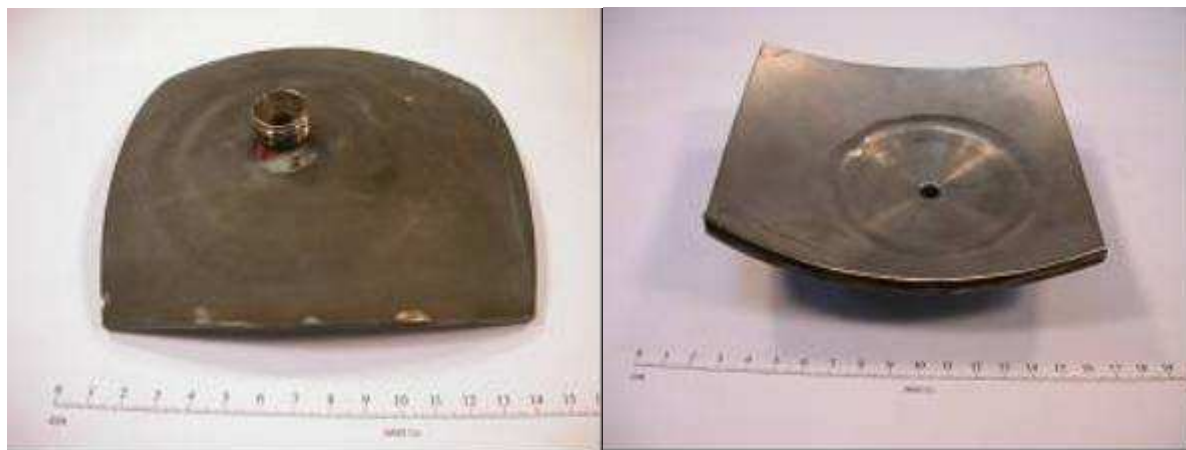
Rys.27. Widok powierzchni zewnętrznej i wewnętrznej wycinka K14, króciec napełniania.
