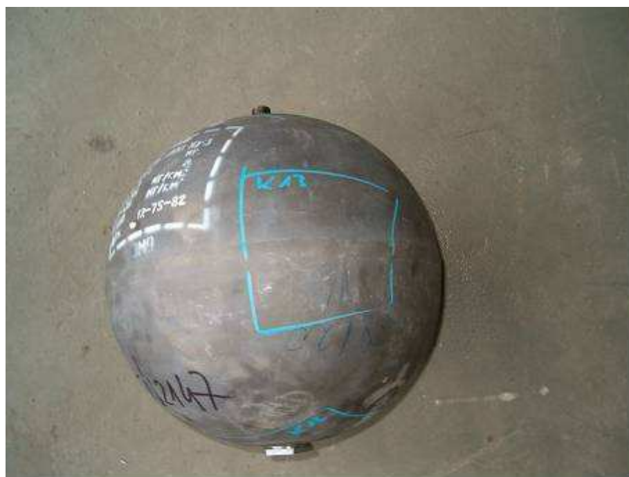
Rys.17. Wycinek K13 z obwodowym połączeniem i fragmentami płaszcza zbiornika.
