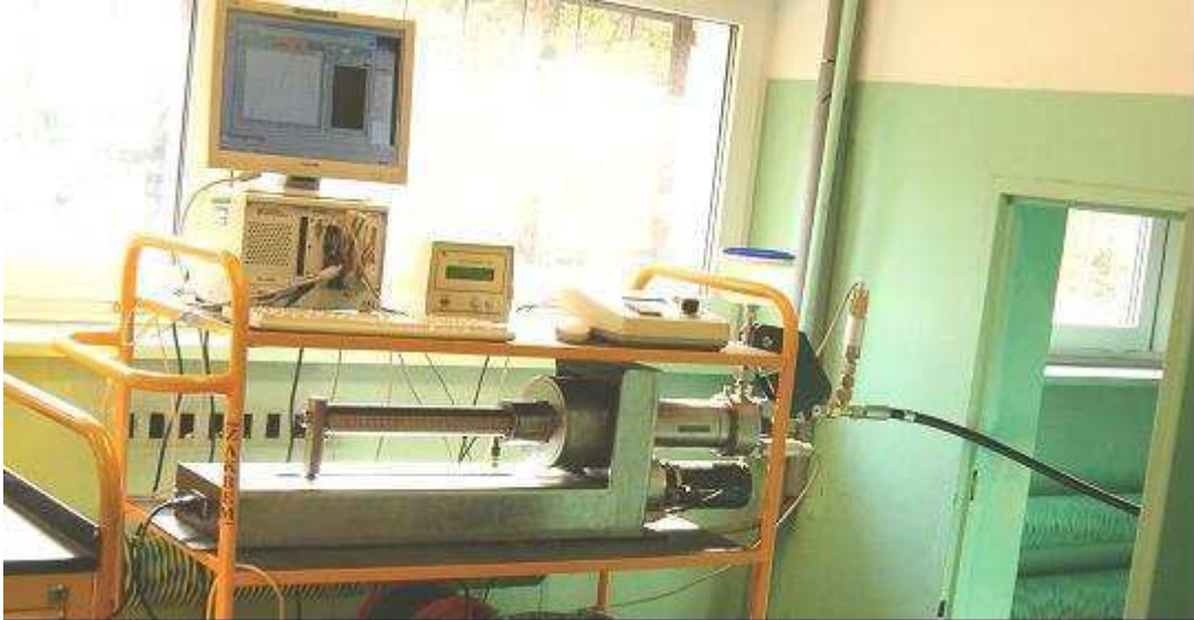
Rys.10. Widok stanowiska laboratoryjnego do hydraulicznej próby wytrzymałościowej zbiornika.
