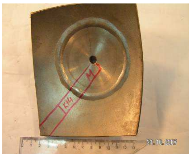
Rys.28. Zdjęcie elementu K14 ze spoiną króćca napełniania z zaznaczonym miejscem pobrania próbki metalograficznej
