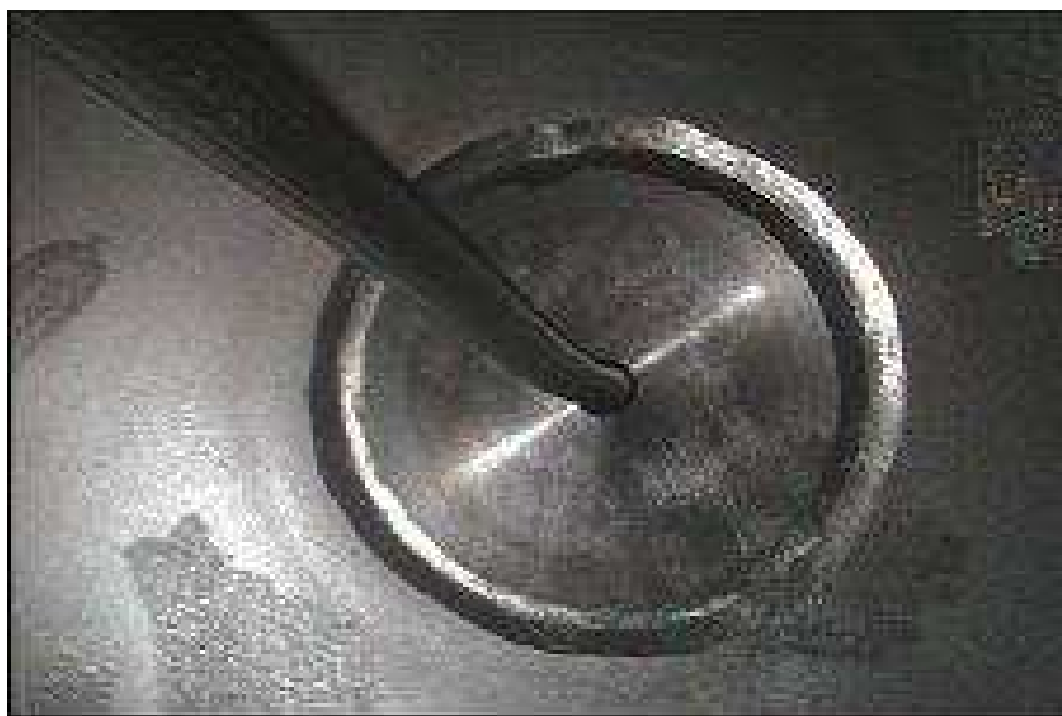
Rys.5. Wnętrze zbiornika, widoczne połączenie spawane króćca napełniania, nierównomierna grań spoiny, przetop pełny, widoczne ślady powierzchniowych zczyszczeń.
