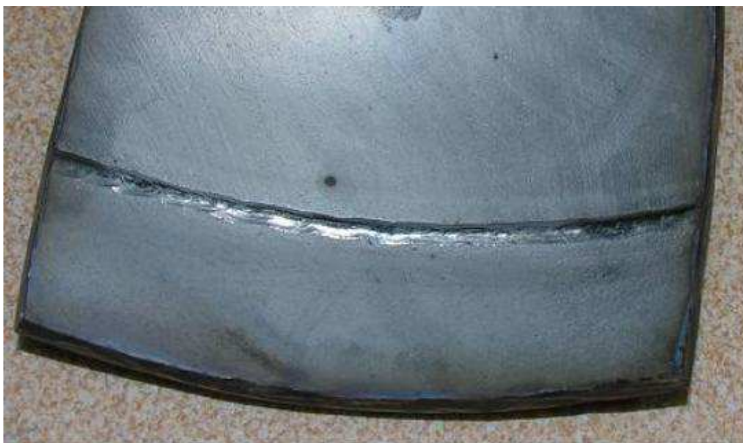
Rys.19. Próbką K17 z widocznym wtrąceniem w okolicy połączenia spawanego.
