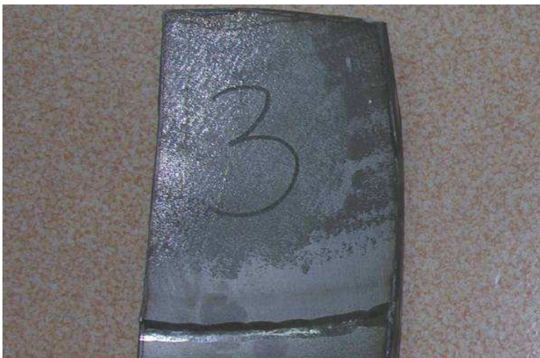
Rys.20. Wycinek K-19 ze śladami zacyszczeń.
