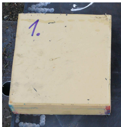
Rys. 8. Panel osłonowy chroniący przed skutkami detonacji.
