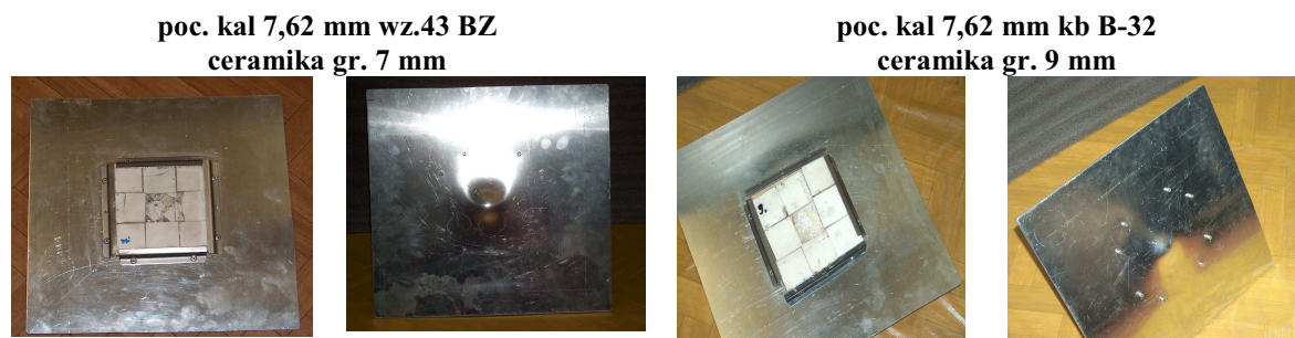
Rys. 1. Próbkki pancerzy po badaniach.
