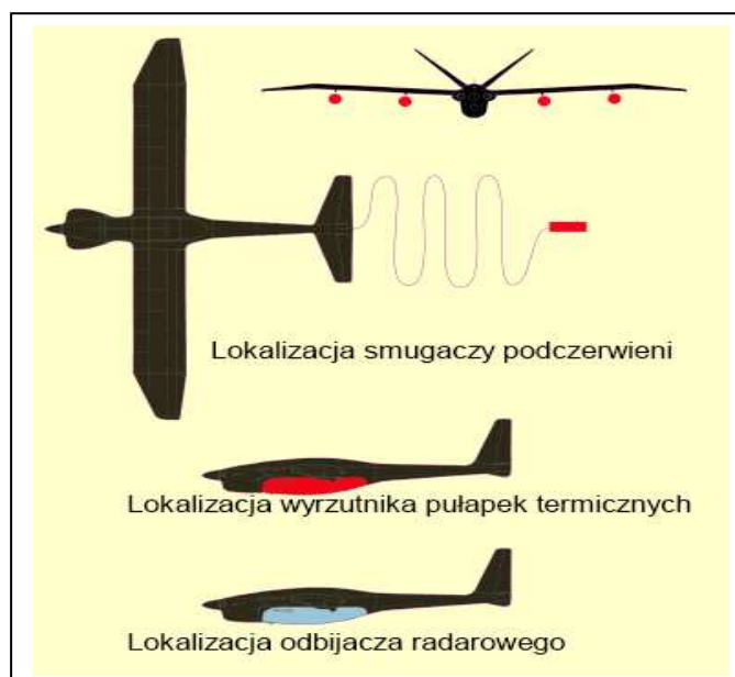
Rys. 8. Lokalizacja opcjonalnych urządzeń na pokładzie samolotu-celu
