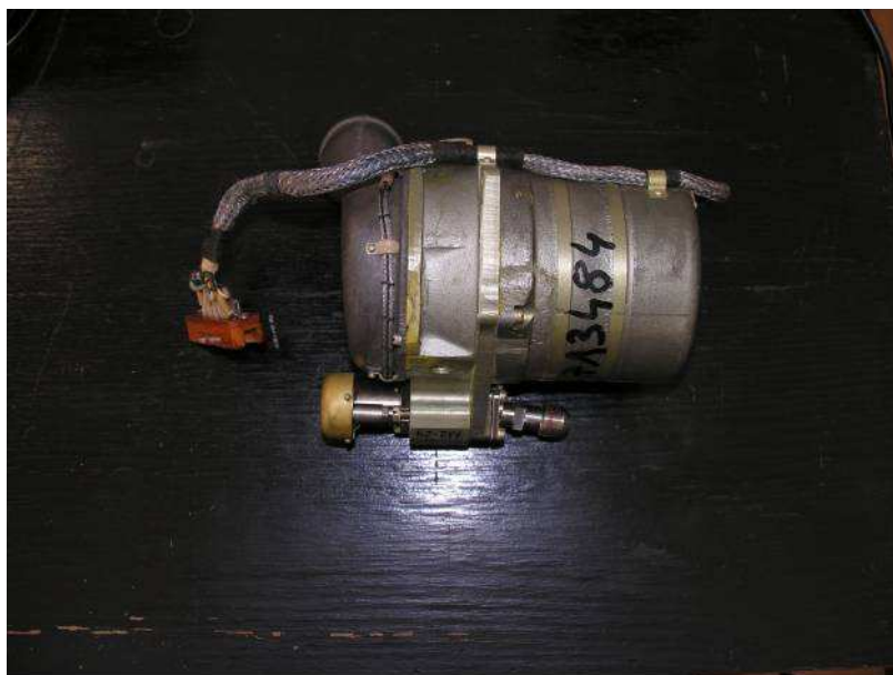
Fot.3. Turbogenerator po reklimatyzacji
