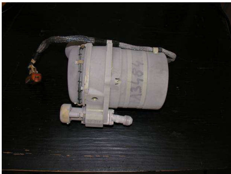
Fot.2. Turbogenerator przygotowany do badań w temperaturze -40^{\circ}\text{C}
