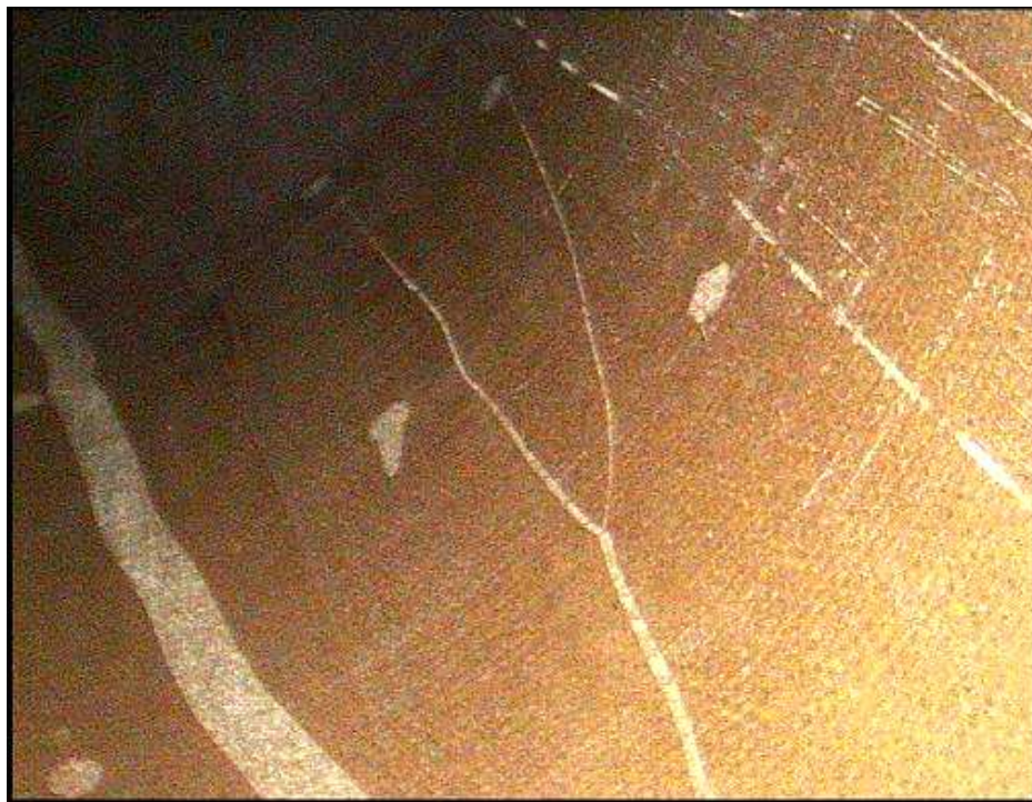
Fot 6 i 7. Wnętrze komory spalania rakiety KUB - ubytki, pęknięcia i podwinięcia zewnętrznej warstwy wykładziny termicznej.
