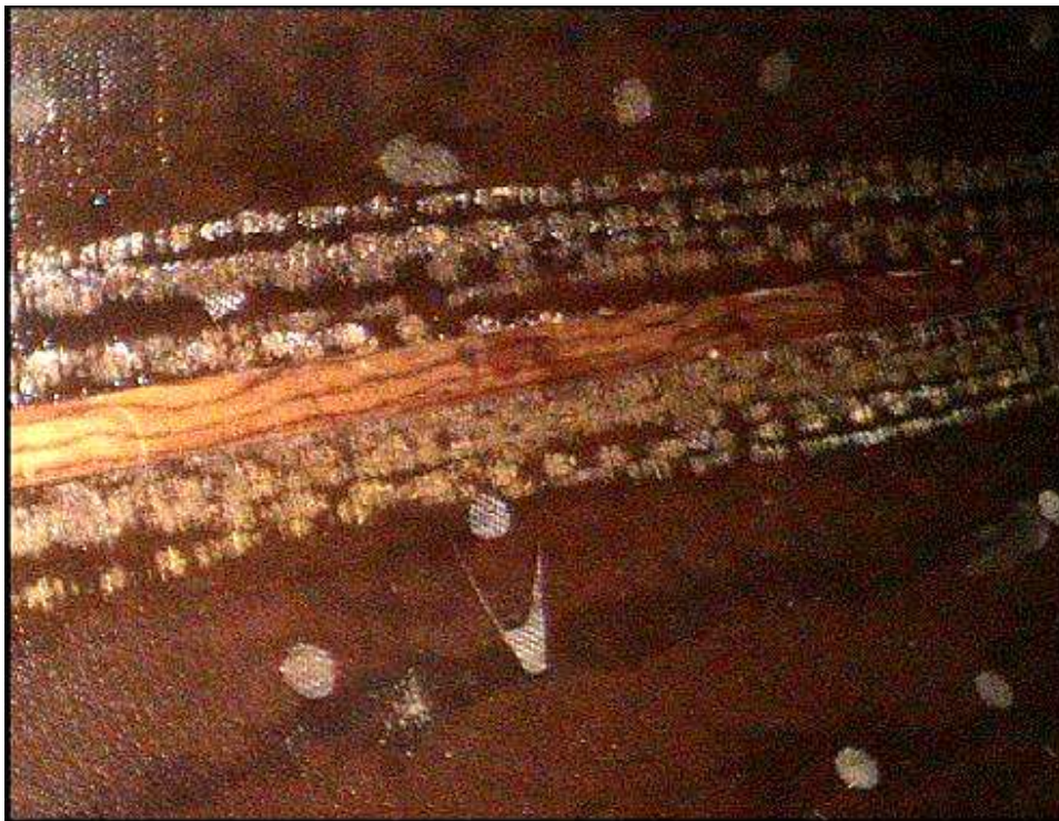
Fot.11 i 12. Wnętrze komory spalania rakiety KUB: starcia powierzchniowe wykładziny termicznej.
