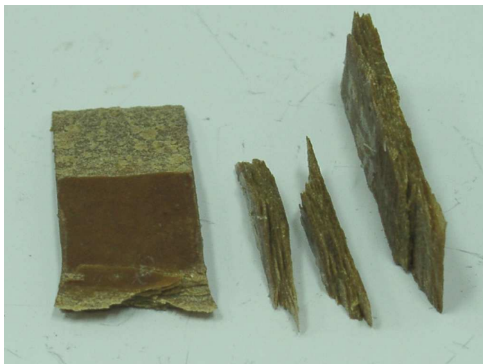
Fot.17. Kruche kawałki wykładziny termicznej po oddzieleniu od podłoża i poddane próbie zginania. Pow. 2x.
