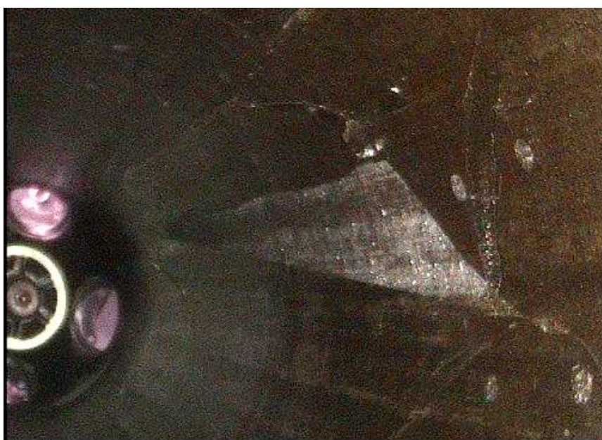
Fot.3. i 4. Wnętrze komory spalania rakiety KUB: widoczne braki i uszkodzenie zewnętrznego pokrycia wykładziny termicznej.
