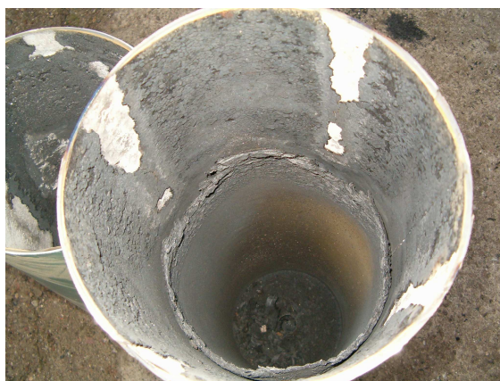
Fot.14. Wnętrze komory spalania – widok po odcięciu tylnej części wraz z dyszą.
