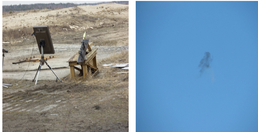
Rys. 1 Załadowany nabój KO-7M oraz moment zadziałania samolikwidatora Źródło: opr. wł.
