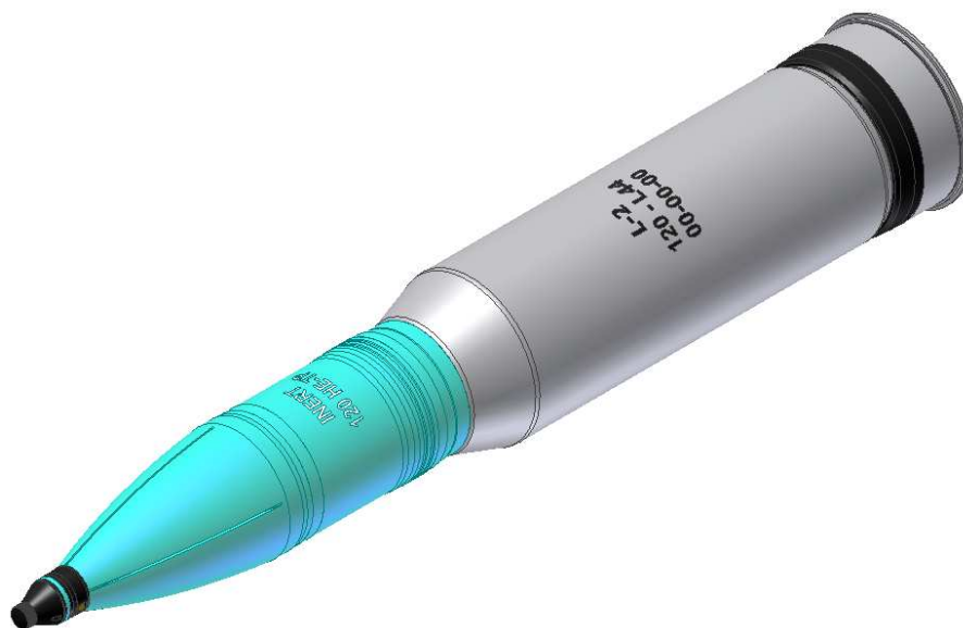
Rys. 4 Nabój z pociskiem odłamkowo-burzącym ćwiczebnym (HE-TP) zaelaborowanym materiałem obojętnym do armaty Rh120 L44 czołgu Leopard 2A4.
