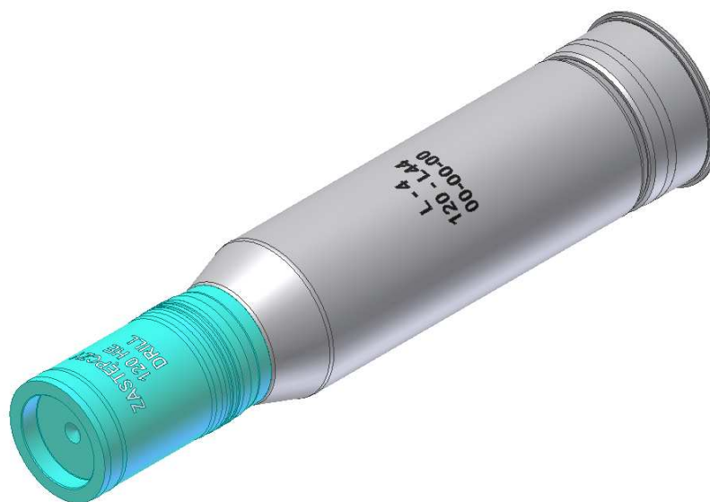
Rys. 6 Nabój z pociskiem odłamkowo-burzącym (HE) zastępczym do armaty Rh120 L44 czołgu Leopard 2A4.
