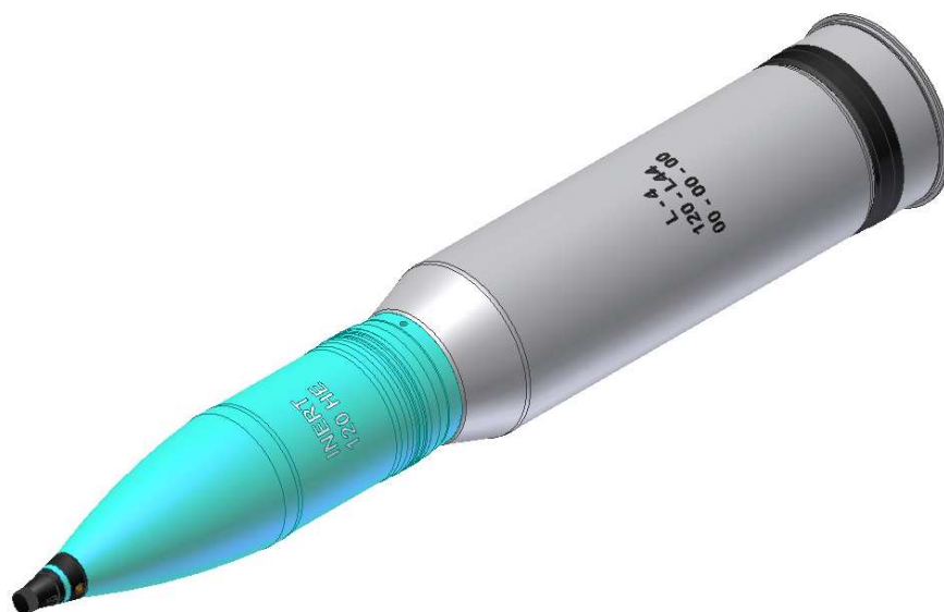
Rys. 3 Nabój z pociskiem odłamkowo-burzącym (HE) zaelaborowanym materiałem obojętnym do armaty Rh120 L44 czołgu Leopard 2A4.
