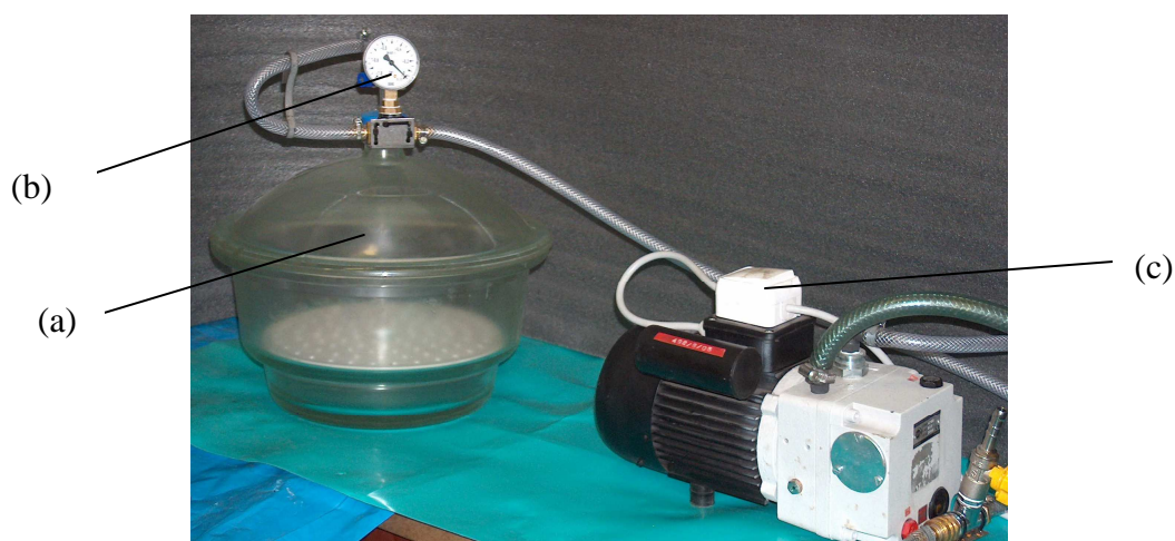
Rys. 4. Układ odpowietrzający: a) eksykator, b) manometr próżniowy, c) pompa próżniowa.
