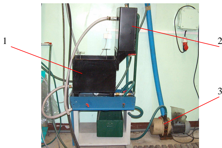
Rys. 10. Fotografia stanowiska do uzyskiwania kształtek włóknistych: (1) zbiornik zawiesiny, (2) zbiornik przelewowy, (3) pompa próżniowa.
