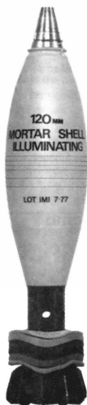
Rys. 5. 120 mm moździerzowy pociski oświetlający M2 Źródło: [Lit. 2]
