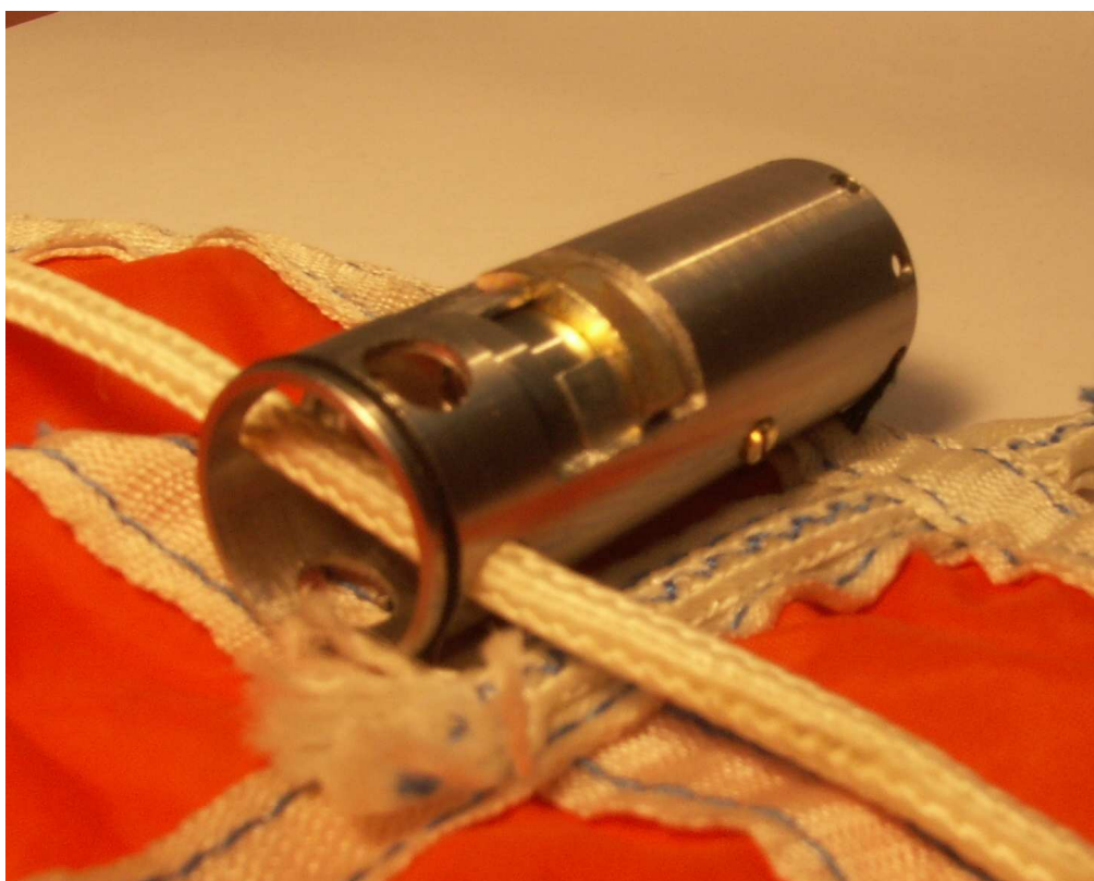
Rys. 8. Model przecinaka przeznaczony do 98 mm pocisku oświetlającego. Źródło: opr. wł.
