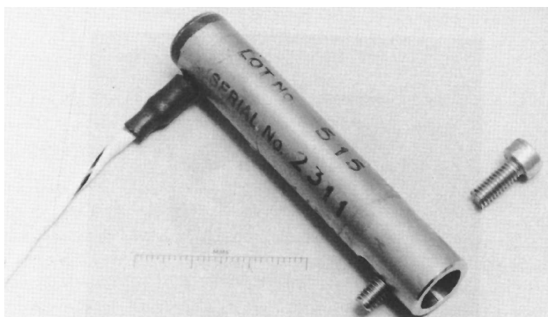
Rys. 7. Przecinak wkrętów uwalniający elementy mechaniczne Źródło: [Lit. 1]
