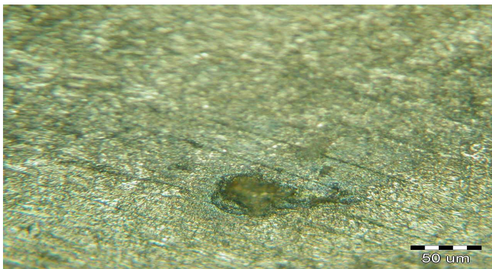
Rys.8. Szlif poprzeczny spoiny po wytrawieniu nitałem. Widoczna mikrostruktura odpuszczonego martenzytu oraz globularne wtrącenie. Pow. 380x.
