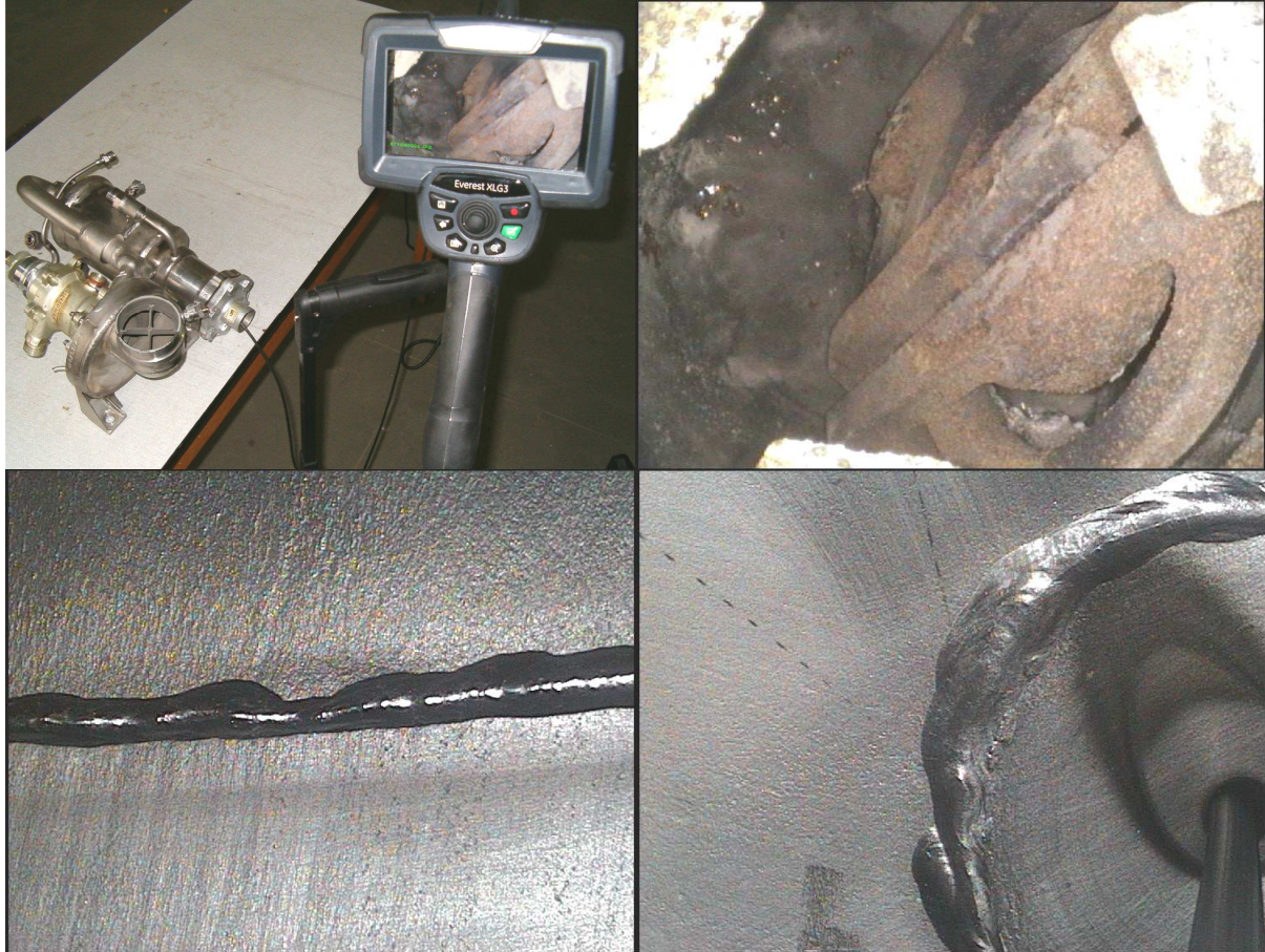
Rys. 6. Przykładowe obrazy z badań endoskopowych. Widok korozji wewnątrz pompy silnika rakietowego i nierównomierność spawów zbiorników wysokociśnieniowych.
