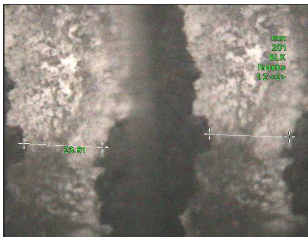
Rys. 3. Przykładowy pomiar szerokości wypalanej okładziny termicznej w silniku rakiety dla niskiego indeksu i niskiej pewności dopasowania wynoszącej 2.
