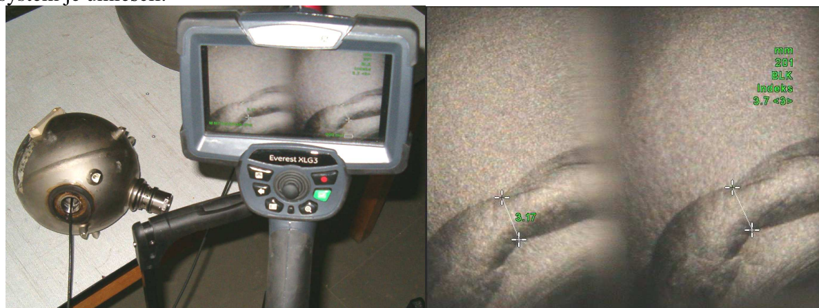
Rys. 5. Pomiar szerokości spawu wewnętrznego raketowego zbiornika powietrza na ciśnieniu 275 atm.
