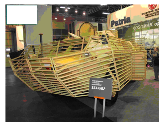
Rys.3. Opancerzony pojazd rozpoznawczy BRDM-2 „Szakal” z ażurową ochroną pancerną
