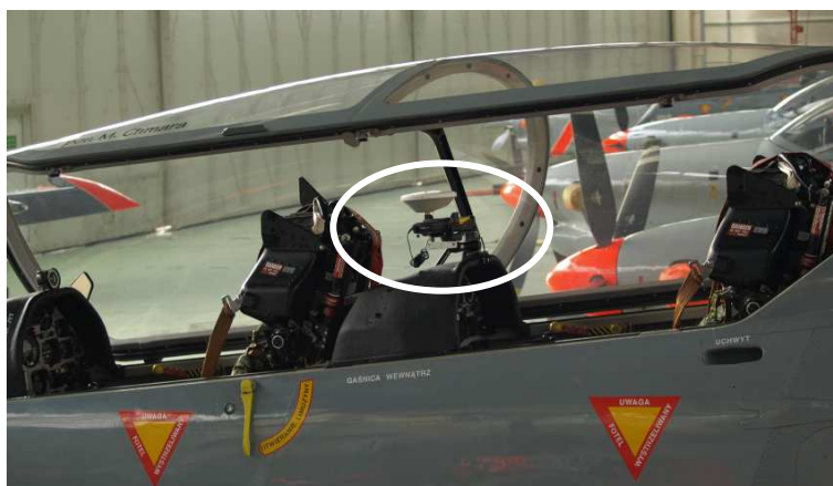
Rys.4 Odbiornik GPS Trimble R3 zamontowany w kabinie samolotu PZL 130 Orlik
