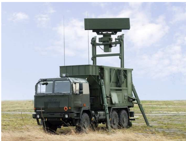
Rys.3 Radar NUR-22N-(3D) w pozycji pracy bojowej [www.rawar.com.pl]
