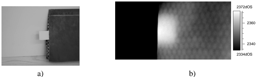
Rys. 4. Zdjęcie (a) fragmentu kompozytu typu plaster miodu z uszkodzeniem w postaci oderwania kilku komórek z rdzenia kompozytu od pokrycia, fazogram (b) tego fragmentu z widocznym uszkodzeniem (jasna plama) wykonany metodą optyczną termografią lock-in (4-ro punktową) z f = 0,03 Hz
