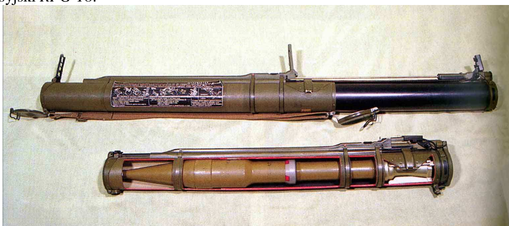
Rys.1.7. Rosyjski granatnik jednorazowego użytku RPG-18.
