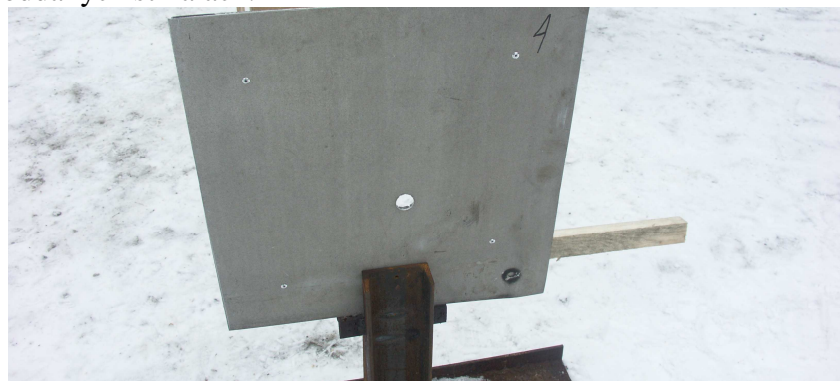
Fot. 7. Widok tarczy- celu od strony przedniej (wlot pocisku). Strzał nr 4.
