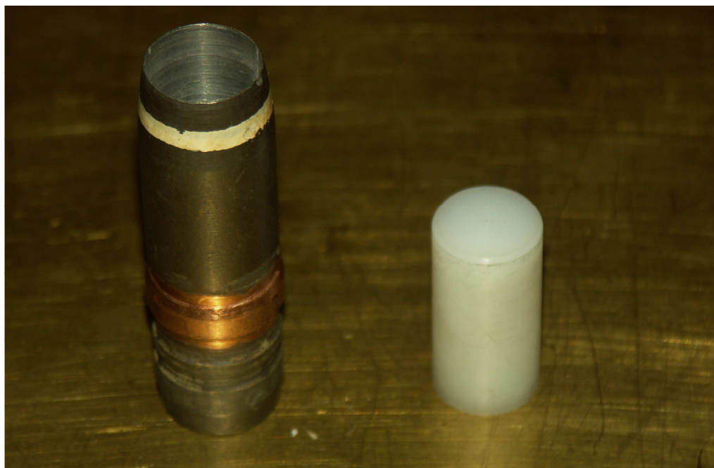
Fot. 5. Pocisk kinetyczny PELEb przygotowany do montażu. Rdzeń poliamidowy widoczny z prawej strony.
