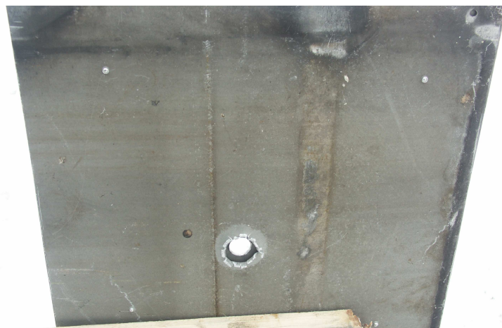
Fot. 8. Widok tarczy - celu od strony tylnej (wylot pocisku).
