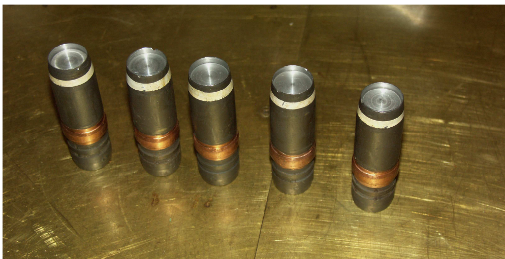
Fot. 4. Pociski kinetyczne PELEa, z rdzeniem ze stopu aluminium.
