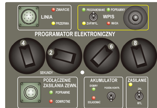
2. Pomiar odległości do celu – automatyczny transfer czasu lotu pocisku do programatora
