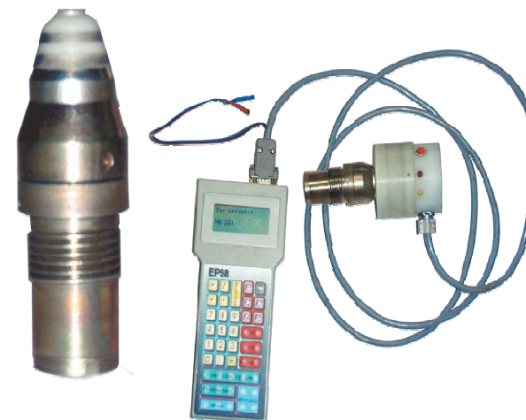
3. Automacyjne zaprogramowanie zapalnika elektronicznego za pośrednictwem złącza elektrycznego iglicy i zapłonika naboju (na lewo) lub awaryjnie za pomocą ręcznego programatora stykowego (na prawo). Wystrzelenie pocisku.
