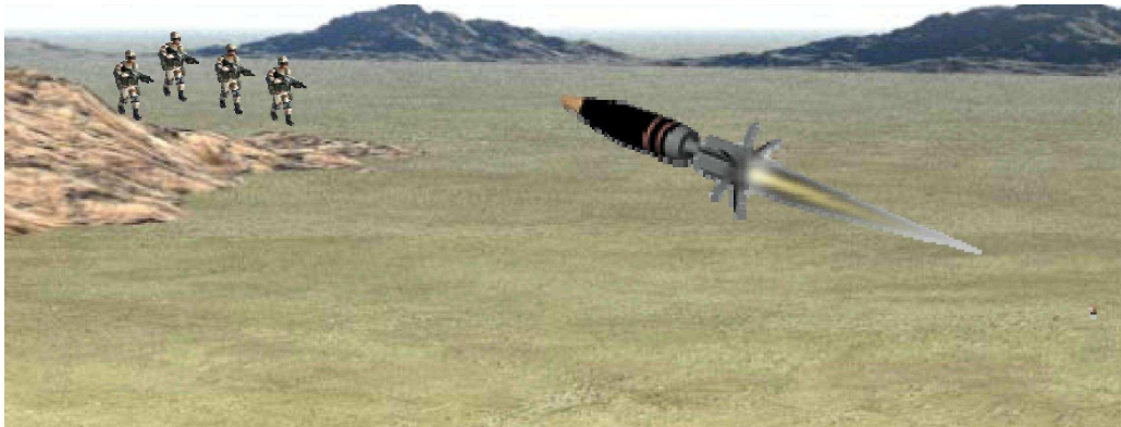
3. Wystrzelenie pocisku i automatyczne zaprogramowanie zapalnika elektronicznego za pośrednictwem zewnętrznego elementu radiolokacyjnego.
