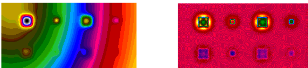
Rys.3. Poprawa ostrości zobrazowania defektów za pomocą wysokoczęstotliwościowej filtracji (zobrazowanie symulacyjne)
