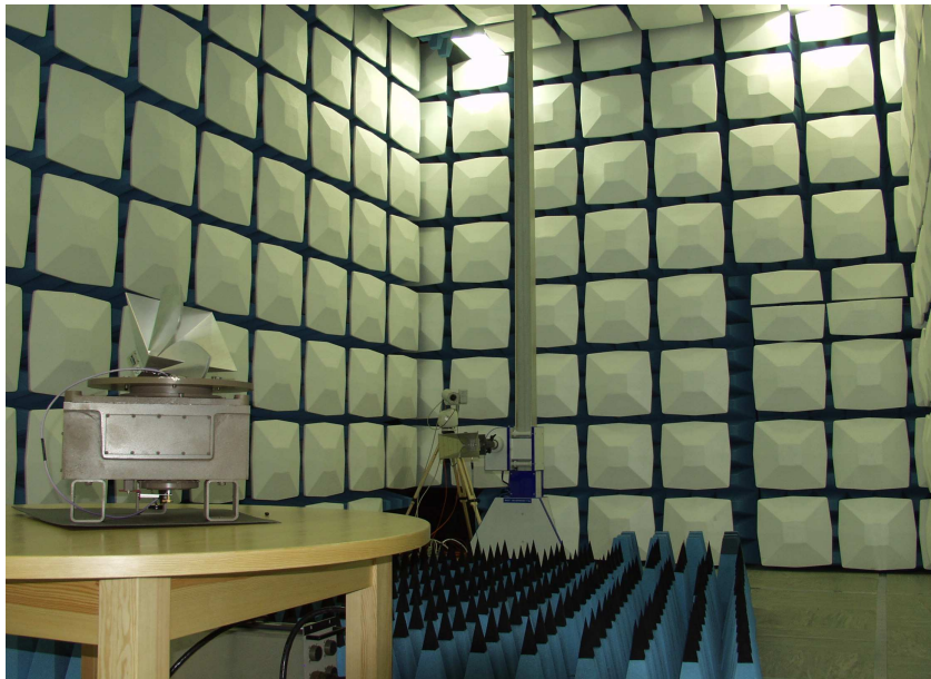
Rys. 2. Komora od środka z widocznym systemem do pomiaru charakterystyk promieniowania anten i masztem
