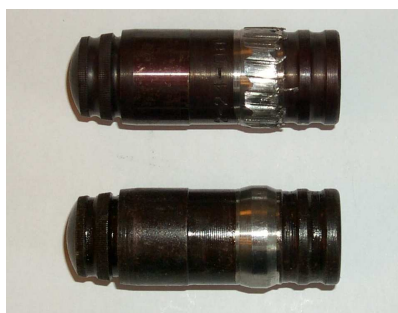
Rys. 6. Obraz pierścieni wykonanych z niskowęglowej stali przed i po próbie statycznego przepychania przez lufę
