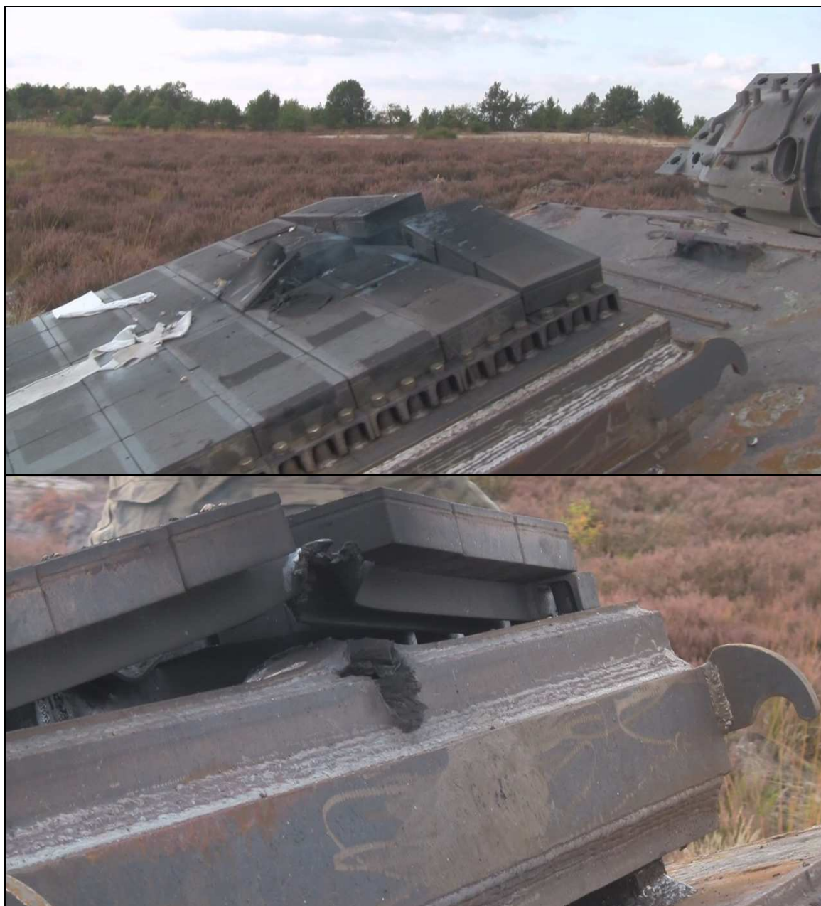
Rys. 1. Rykoszetowanie pocisku DM-33A1 od modelu pancerza czołgu PT-91M [1].
