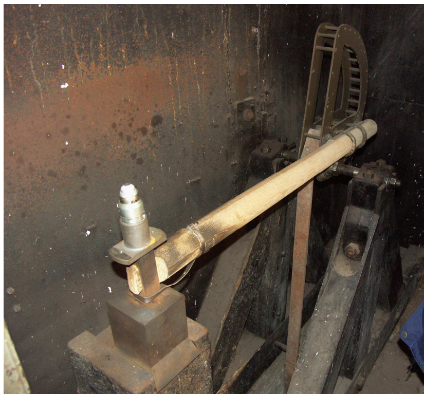
Foto 1. Układ czasowy przygotowany do badania odporności i wytrzymałości na udary mechaniczne na młocie Masseta.
