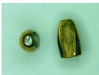
Fot 3. Pocisk 9x19 mm OR po uderzeniu w płytę stalową o grubości 10mm ( \Theta=75^\circ ) ( \Theta=45^\circ )
