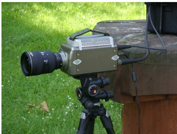
Fot 2. Kamera do zdjęć szybkich Phantom v7.3, na stanowisku badawczym podczas rejestracji zjawiska rykoszetowania pocisków.
