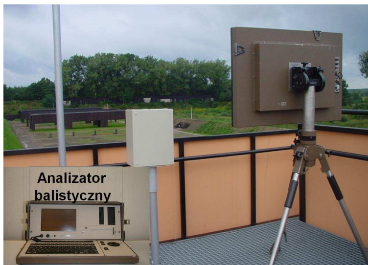
Fot.1. Dopplerowski zestaw balistyczny DR-5000 z anteną ED-6200 ustawiony na obiekcie strzelnicy garnizonowej, celem rejestracji rykoszetu pocisków.
