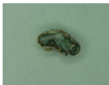
Fot 4. Pocisk 5,56x45 mm OR po uderzeniu w płytę betonową
