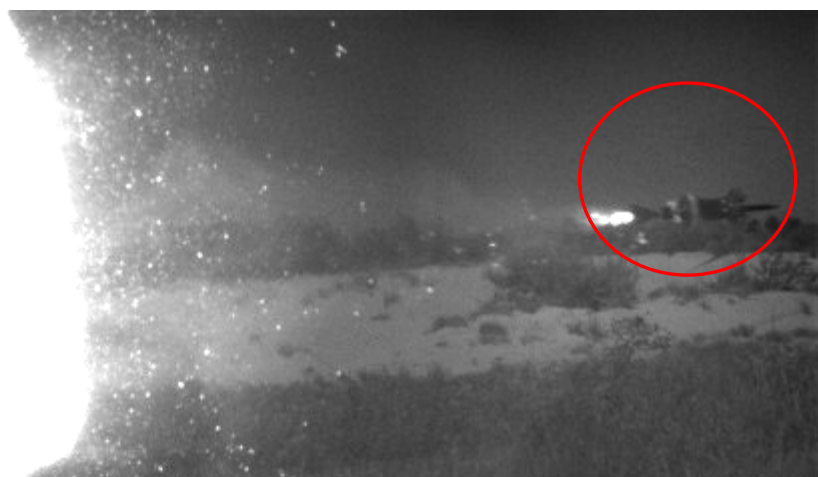
Fot.2.6. Wylot pocisku z lufy armaty balistycznej zarejestrowany przez kamerę do zdjęć szybkich podczas strzału nr 2 – sekwencja nr 5.
