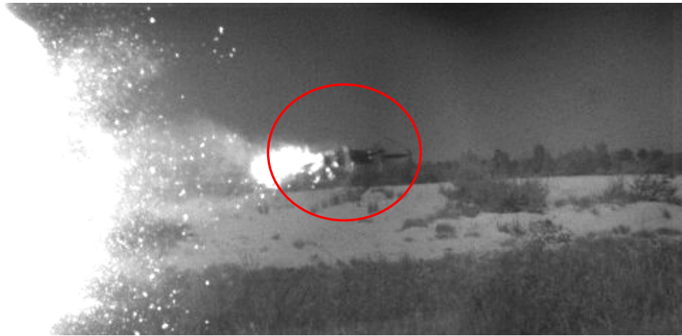
Fot.2.4. Wylot pocisku z lufy armaty balistycznej zarejestrowany przez kamerę do zdjęć szybkich podczas strzału nr 2 – sekwencja nr 3.
