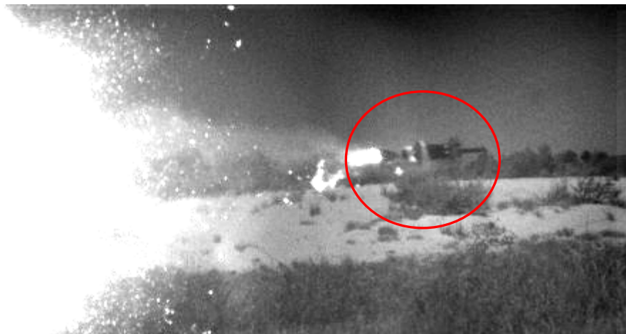
Fot.2.5. Wylot pocisku z lufy armaty balistycznej zarejestrowany przez kamerę do zdjęć szybkich podczas strzału nr 2 – sekwencja nr 4.
