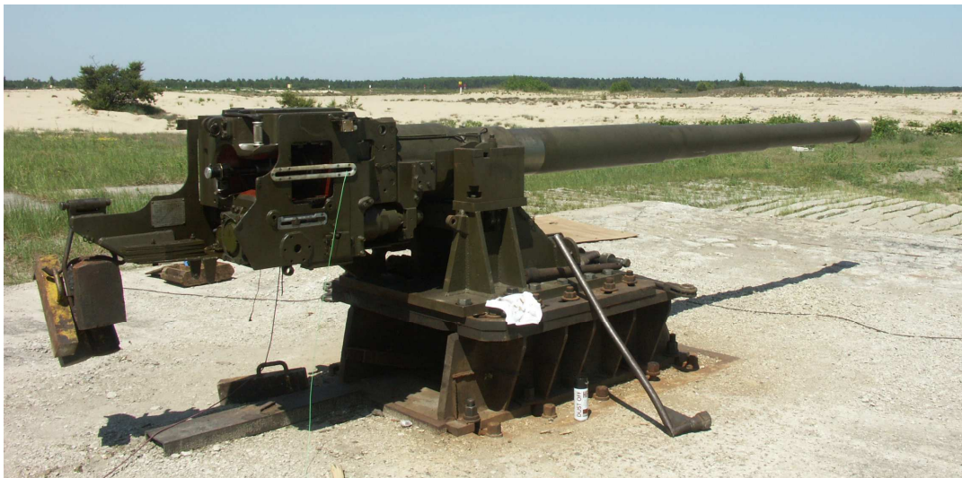
Fot.1.3. 120 mm armata balistyczna L44 zamontowana na stendzie (fot. W. Krajewski).
