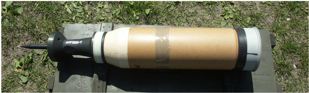
Fot.1.1. 120 mm nabój z modelem pocisku APFSDS-T (fot. W. Krajewski).
