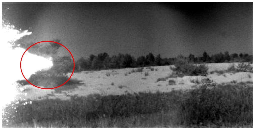
Fot.2.2. Wylot pocisku z lufy armaty balistycznej zarejestrowany przez kamerę do zdjęć szybkich podczas strzału nr 2 – sekwencja nr 1.
